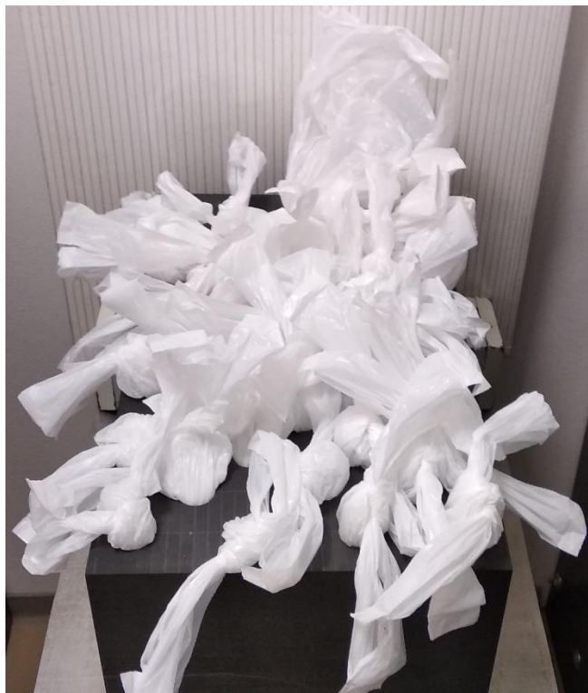
Obr. E.3 Vrecká naplnené soľou NaCl v grafitovej prizme
