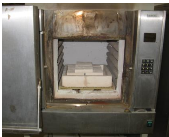
Obr. 11 Vyrobené cihličky na výpal v laboratorní peci
