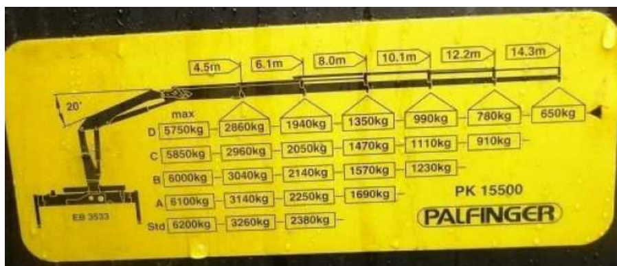
Obrázek 17 Pracovní schéma ramena nákladního auta[66]
