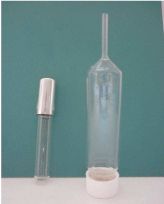
Obrázek 6 Klasická skleněná zkumavka s kovovou zátkou (vlevo) a speciálně upravená zkumavka s vývodem (vpravo)
