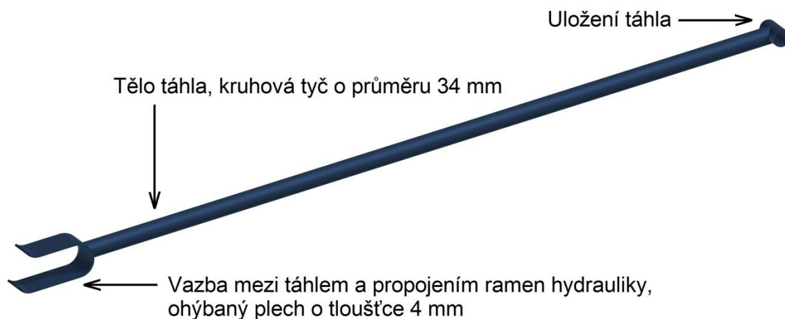
Obr. 20 Konstrukční návrh táhla
