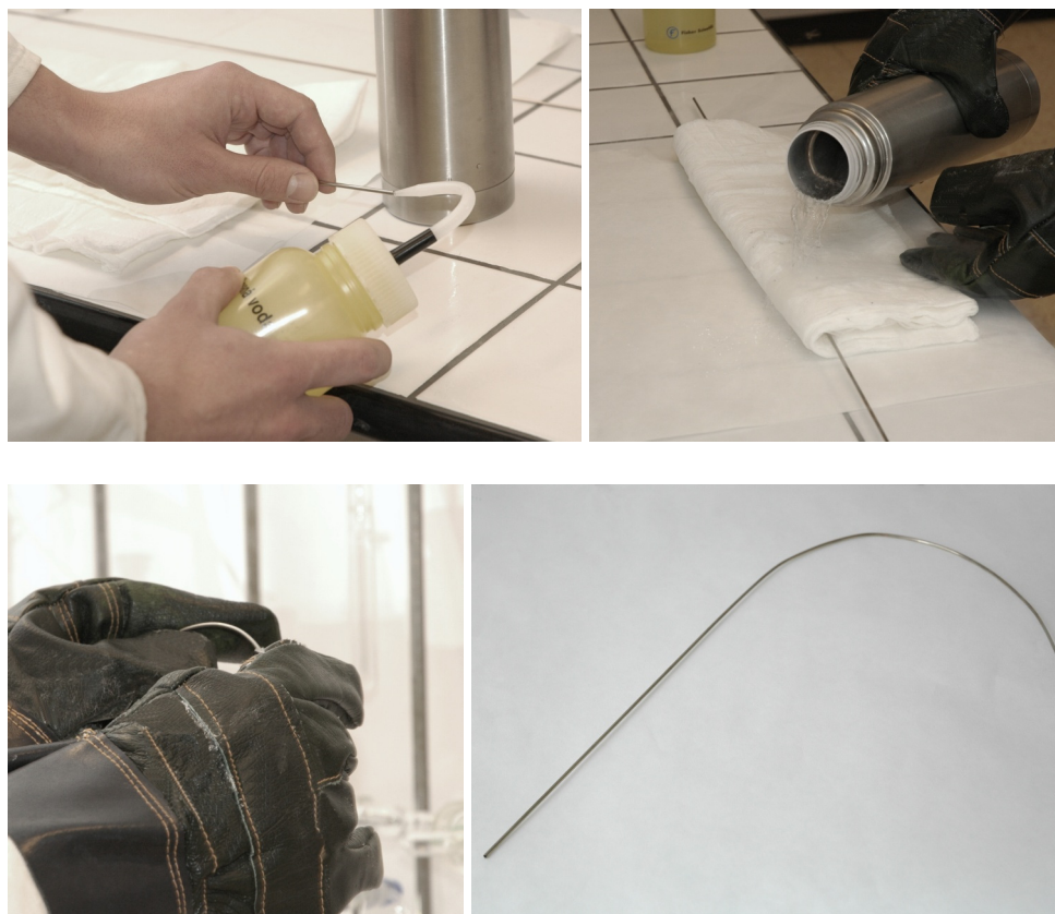
Obr. 12: Postup ohýbání kovové kapiláry
