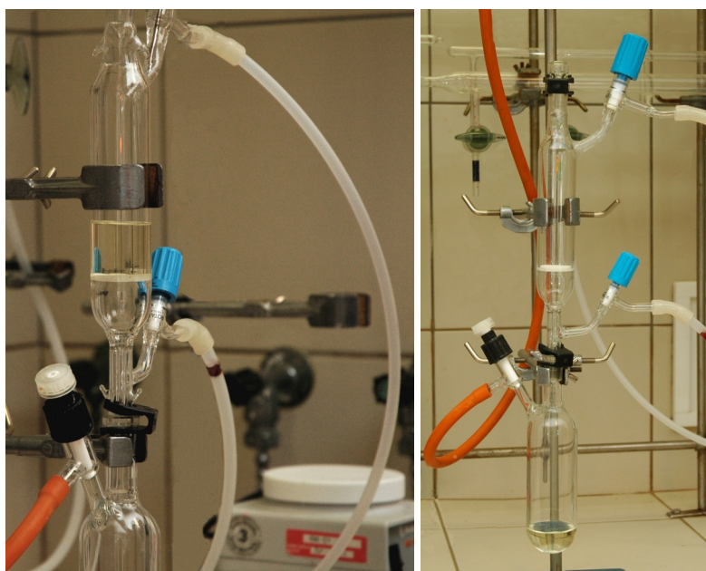
Obr. 31: Aparatura pro filtraci pod inertní atmosférou
