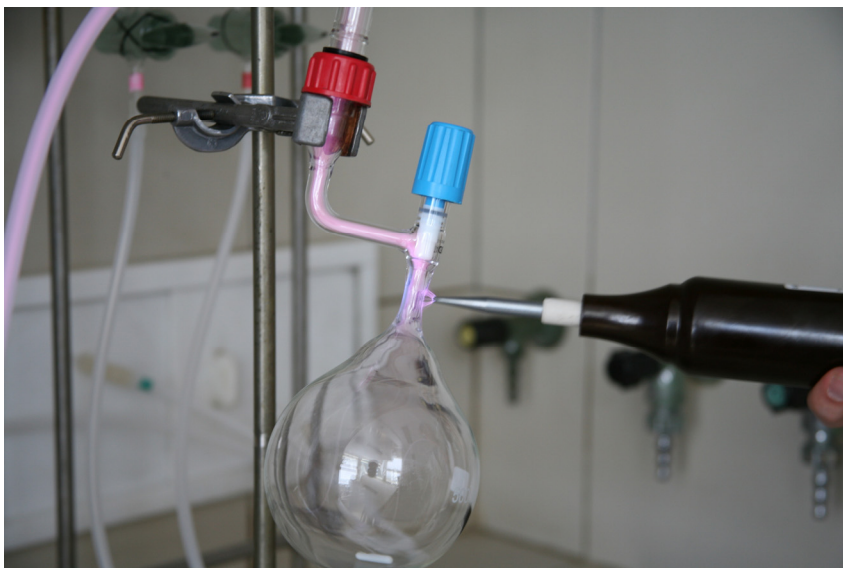
Obr. 8: Charakter výboje indikovaného při hodnotě vakua okolo 1 Pa
