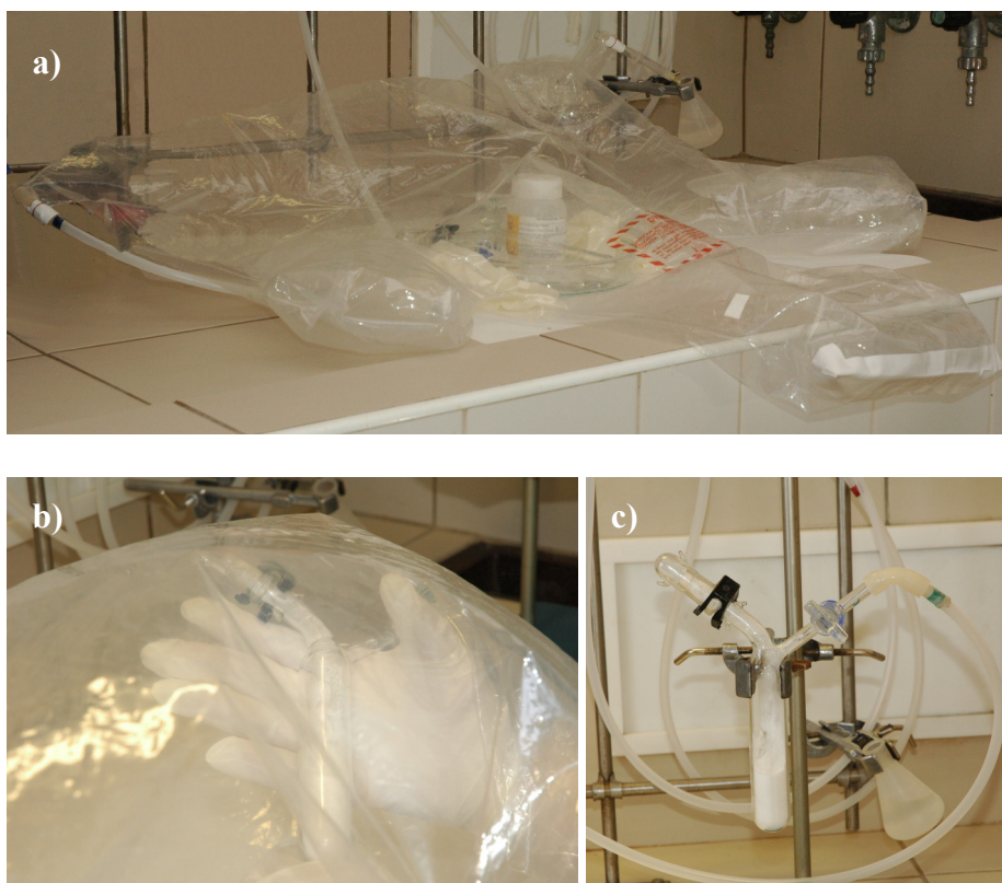
Obr. 20: Postup manipulace v PE pytli: a) umístění všech potřebných komponent do pytle a jeho pročišťování inertním plynem b) ukázka manipulace c) zásobní Schlenkova nádoba obsahující přesypanou pevnou látku
