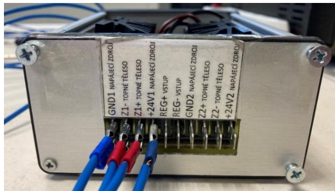
Obrázok 4.9 Zariadenie s riadiacim obvodom pre spínanie výhrevných telies
