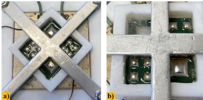
Obrázok 5.3 Pretavenie spájky pri pôsobení mechanických vibrácií: a) 250 Hz, b) 2515 Hz
