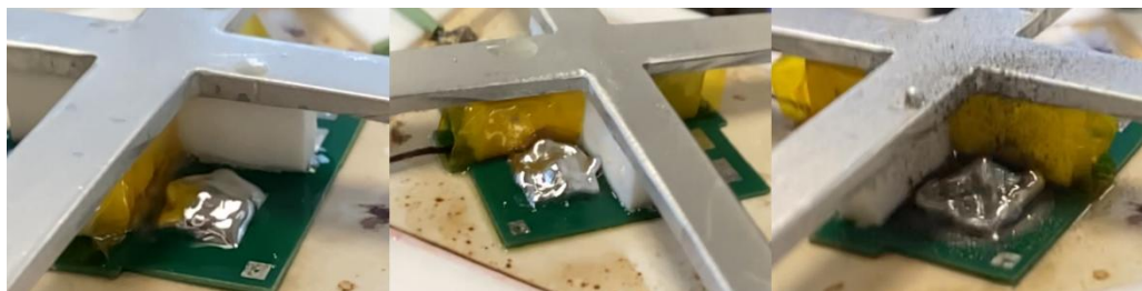
Obrázok 4.17 Dočasné deformácie roztavenej spájky pri nízkych frekvenciách
