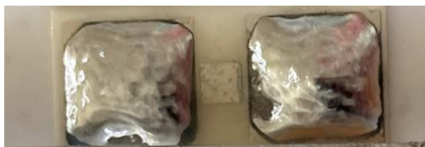
Obrázok 4.13 Prenos vibrácií do spájkovaného spoja počas procesu pretavenia
