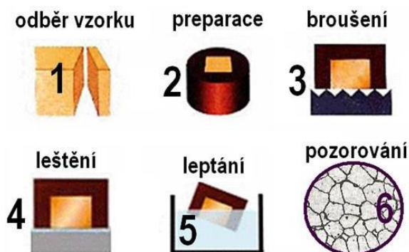
Obrázok 3.1 Postup prípravy metalografického výbrusu [28]
