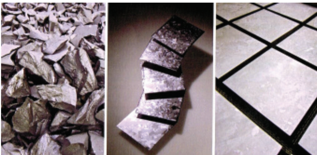
Obr. 2.3 Polykrystalický křemík pro fotovoltaické články. Vlevo surový křemík, uprostřed křemíkové bloky, vpravo křemíkové wafery [7]
