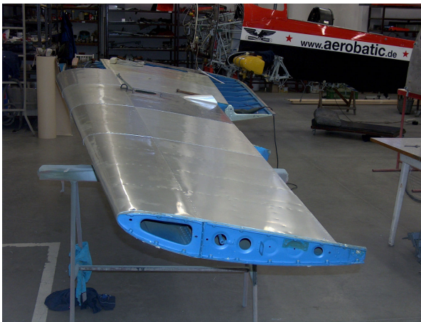
Obr. 11 Křídlo po odstranění starého nátěru
