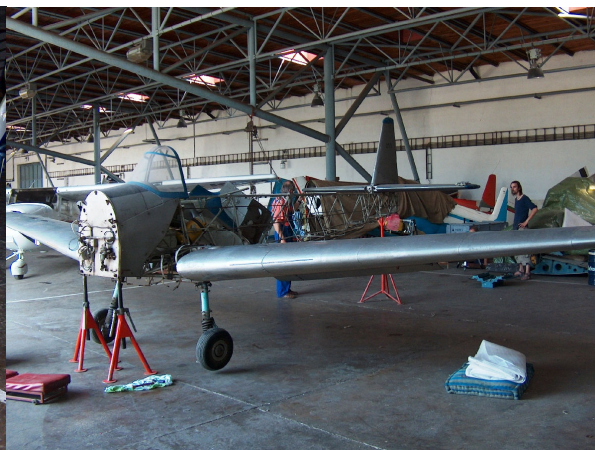
Obr. 8 Tzv. vstupní nivelace před započítím GO
