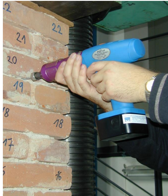
Obr. 19 - Kučerova vrtačka elektrický typ na zkušebním pilíři
