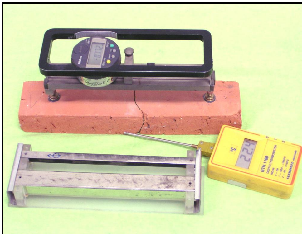
Obr. 21 - Hollanův příložný tenzometr vsazený do kuželovitých závrtů v mosazných terčích připevněných na cihle, kontaktní teploměr a etalony z invaru a oceli
