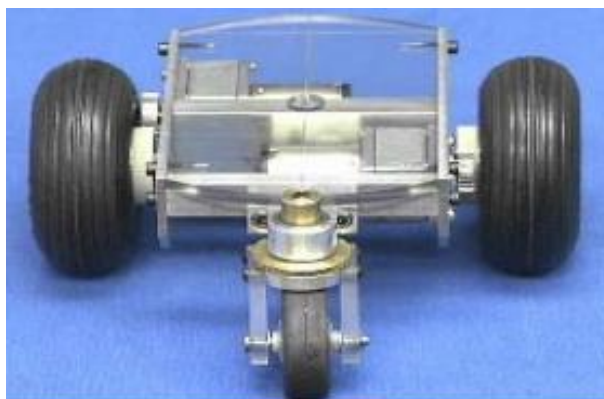
Obr. 22 Trojkolový podvozek s řízeným předním kolem (40)
