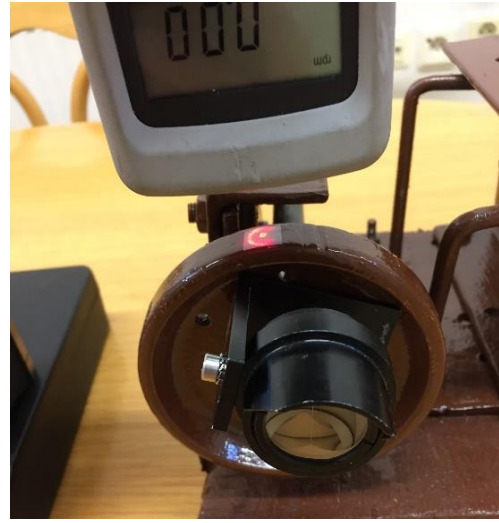
Obrázek 11 – Detail snímání otáček [autor]
