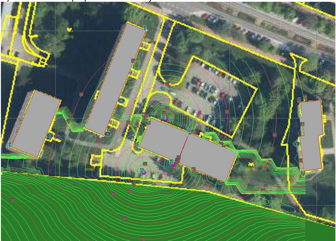
Obrázek 48: Izofony staveniště - výstřižek z programu Hluk+
