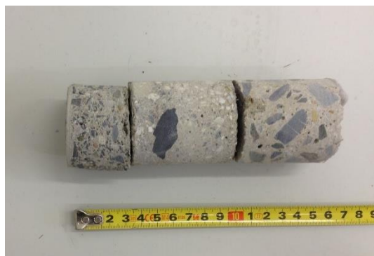
Obrázek 27 Ilustrační obrázek skladby podlahy zjištěnou odvrtem. Zdroj: Autor
