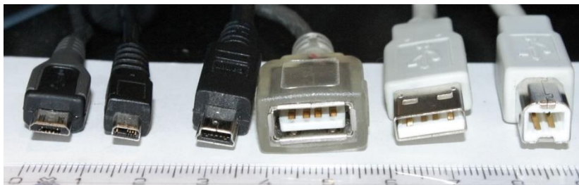
Obr. 8 Typy konektoru zleva micro B, UC E6 USB, mini B, zásuvka typ A, typ A, typ B.
