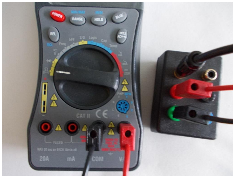
Obr. 12 Ukázka zapojení měřícího obvodu.
