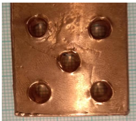
Obrázek 5.6 Detailní záběr děr pokovených folií
