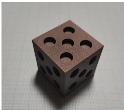
Obrázek 5.13 SLA kostka pokovena vodivým sprejem
