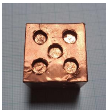
Obrázek 5.12 Stěna SLA kostky pokovena měděnou folií
