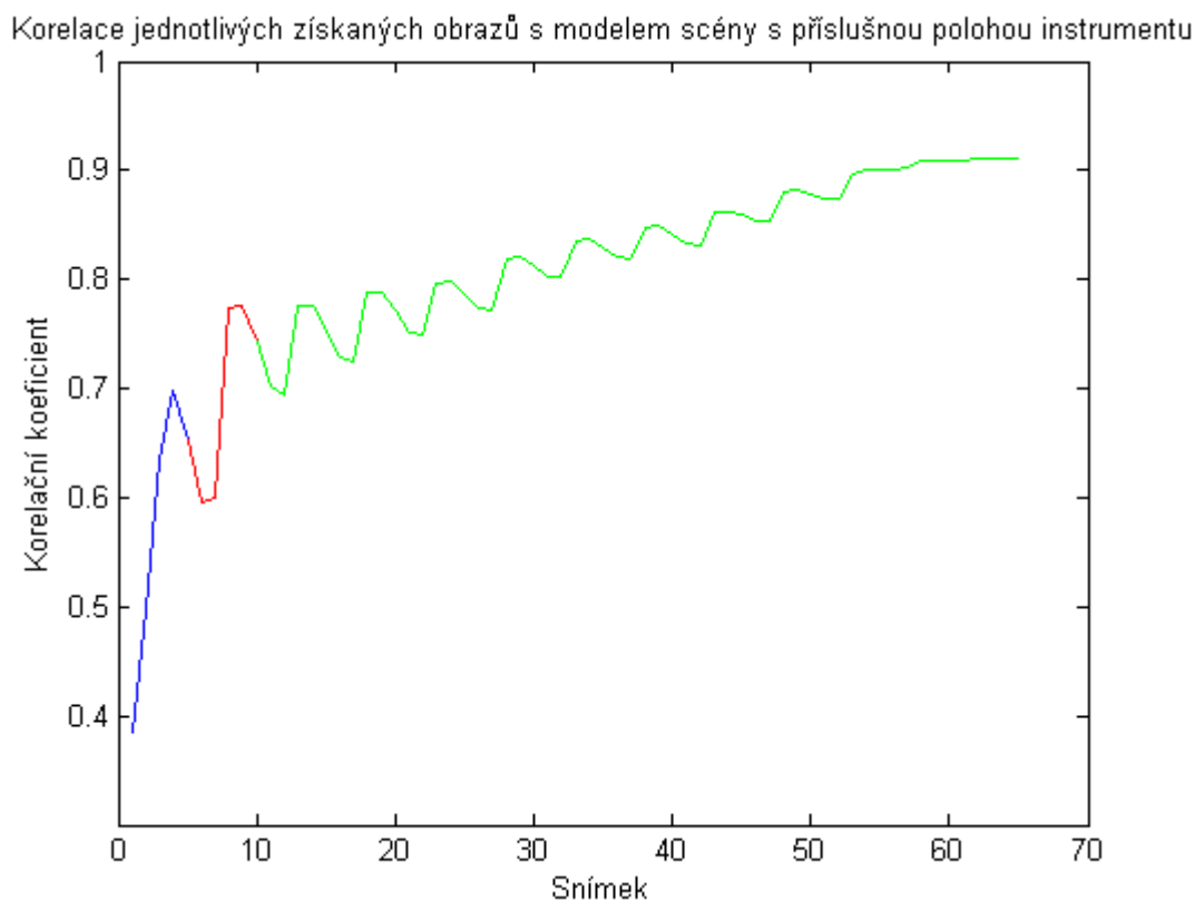
Obrázek 19: Vývoj korelačního koeficientu v čase; zvolené parametry: rychlost rotace gantry 180°/s, 180 projekcí, 10 sektorů, Shepp-logan filtr, rychlost zásunu 8px/s
