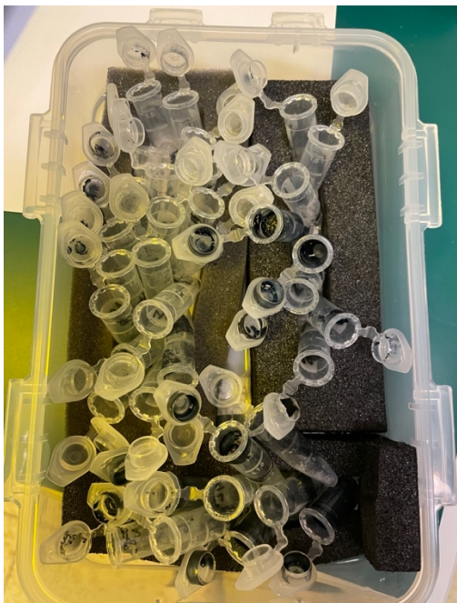
Obrázok 10: rozloženie vzoriek medzi penovými držiakmi vo vzduchotesnej nádobe naplnenej deionizovanou vodou pri rehydratácii xerogélov bezkontaktnou metódou
