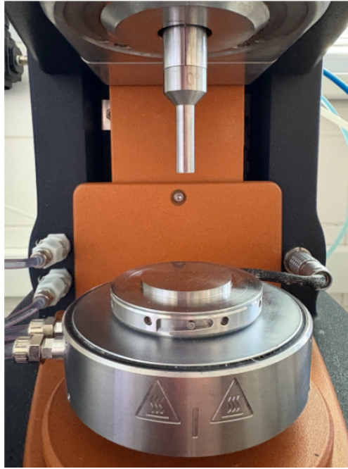
Obrázok 12: usporiadanie geometrií na reometr, vrchná (oscilujúca) a spodná (statická), na obrázku sú geometrie použité na meranie v tejto bakalárskej práci (8mm oscilujúca platňa a 40mm hladká statická platňa)
