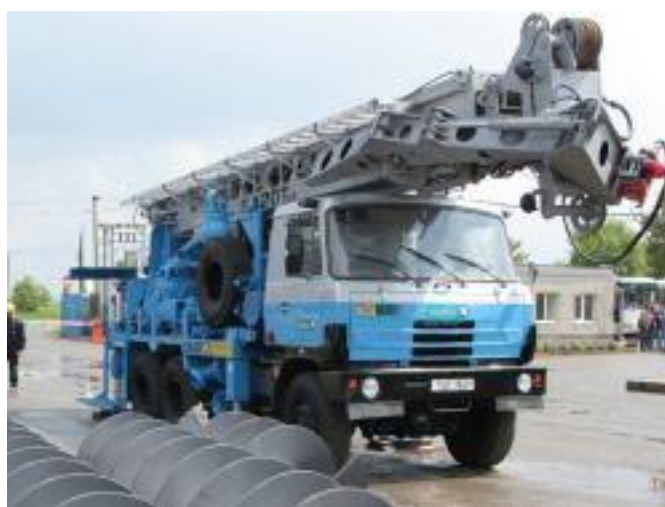
Obr. Vrtná souprava - přepravní poloha
