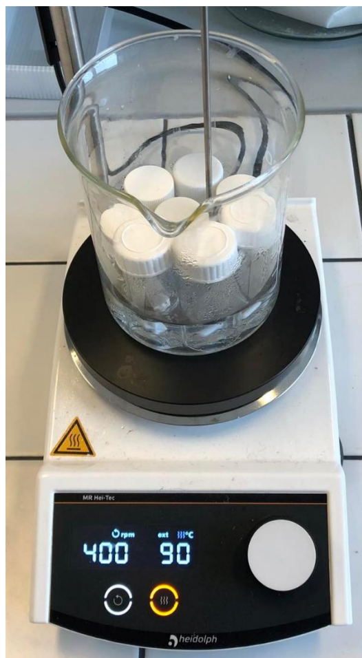
Příloha 1: Aparatura pro přípravu polymerních roztoků s nastavenými parametry.
