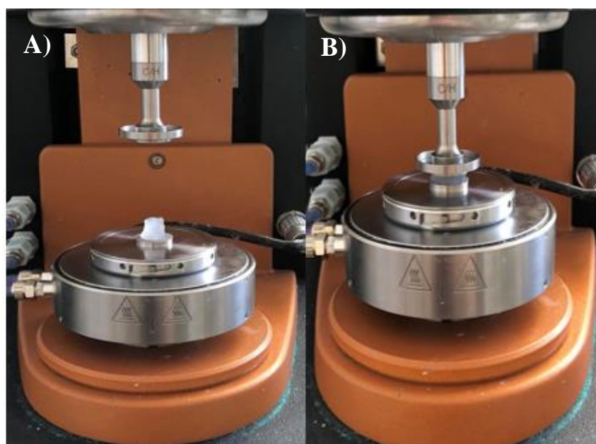
Příloha 2: A) nadávkovaný vzorek pro DMA analýzu B) Stlačený vzorek pro DMA analýzu
