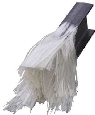
Obr. 7.4 Vyztužení profilu skelnými vlákny [62].
