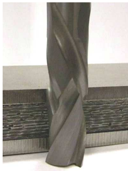
Obr. 7.9 Frézování kompozitu – speciální válcovou frézou [66].
