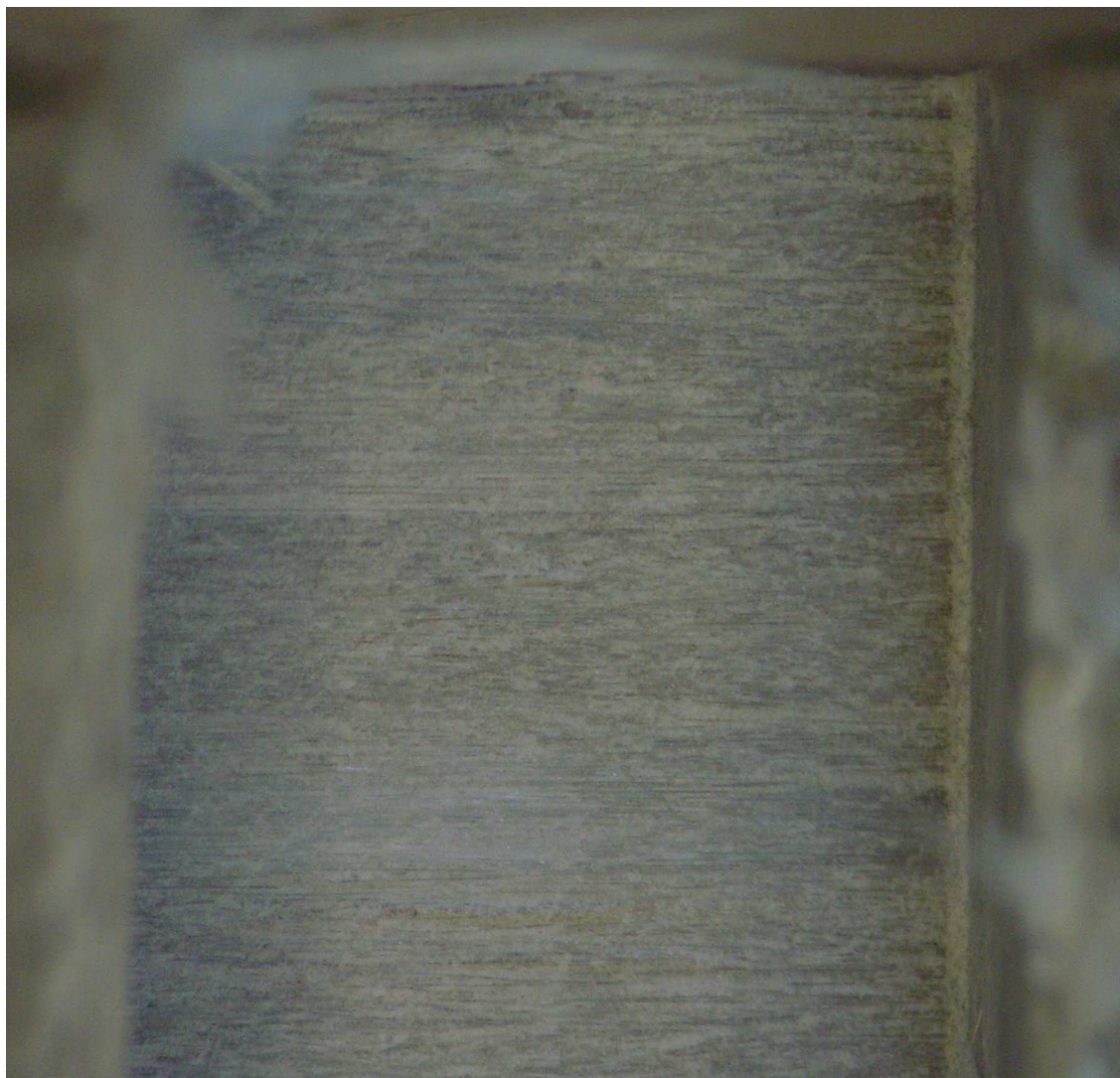
Drážka vyfrézovaná při nastavení orientace vláken kolmo na směr posuvové rychlosti.
