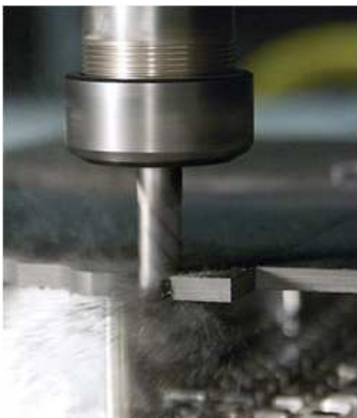
Obr. 7.8 Frézování kompozitu – standardní válcovou frézou [65].
