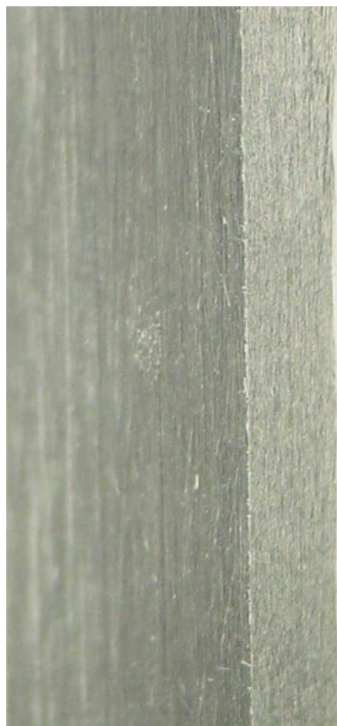
Plocha obrobená při nastavení orientace vláken ve směru posuvové rychlosti
