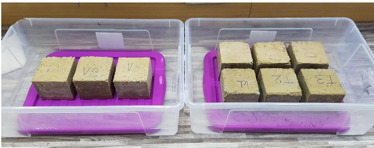
Obrázek 44: Uložení zkušebních těles do stojaté vody hloubky 2 cm
