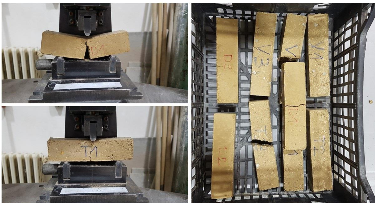
Obrázek 43: Příklady testovaných zkušebních trámečků
