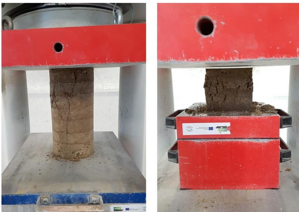
Obrázek 37: Příklady porušení zkušebních těles při provádění zkoušky pevnosti v prostém tlaku
