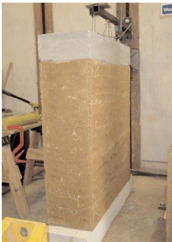
Obrázek 24: Zkouška smykové pevnosti na zkušebním panelu z dusané hlíny [26]
