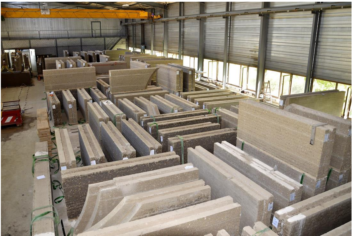
Obrázek 18: Výrobní hala prefabrikátů Martina Raucha pro stavbu haly Ricola ve Švýcarském Laufenu [33]
