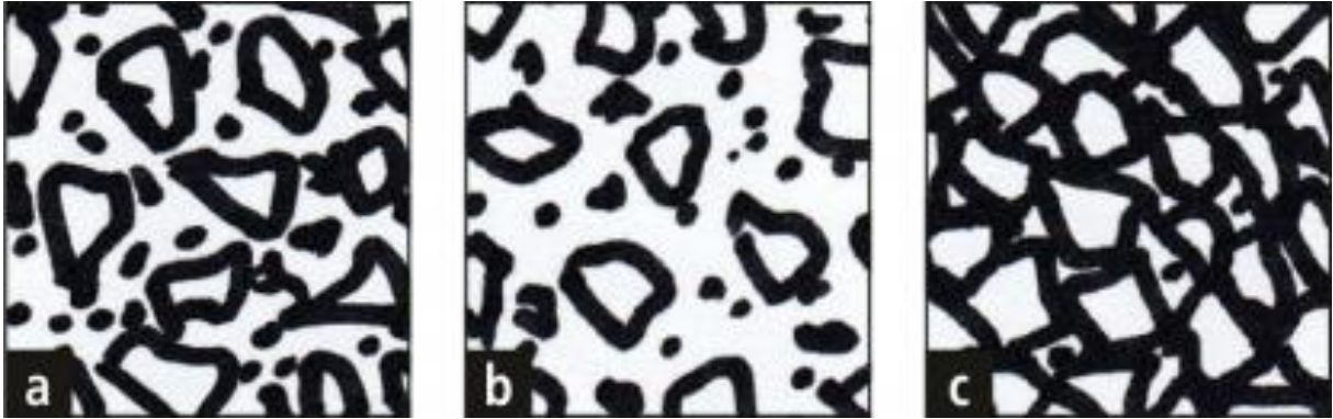
Obrázek 11: Vhodné složení hliněné směsi pro dusání podle zrnitosti; a – vhodný poměr hrubých a jemných částic (směs vhodná pro dusání); b – příliš mnoho jemných částic (nehodné pro dusání); c – příliš mnoho hrubých částic (nehodné pro dusání) [24]
