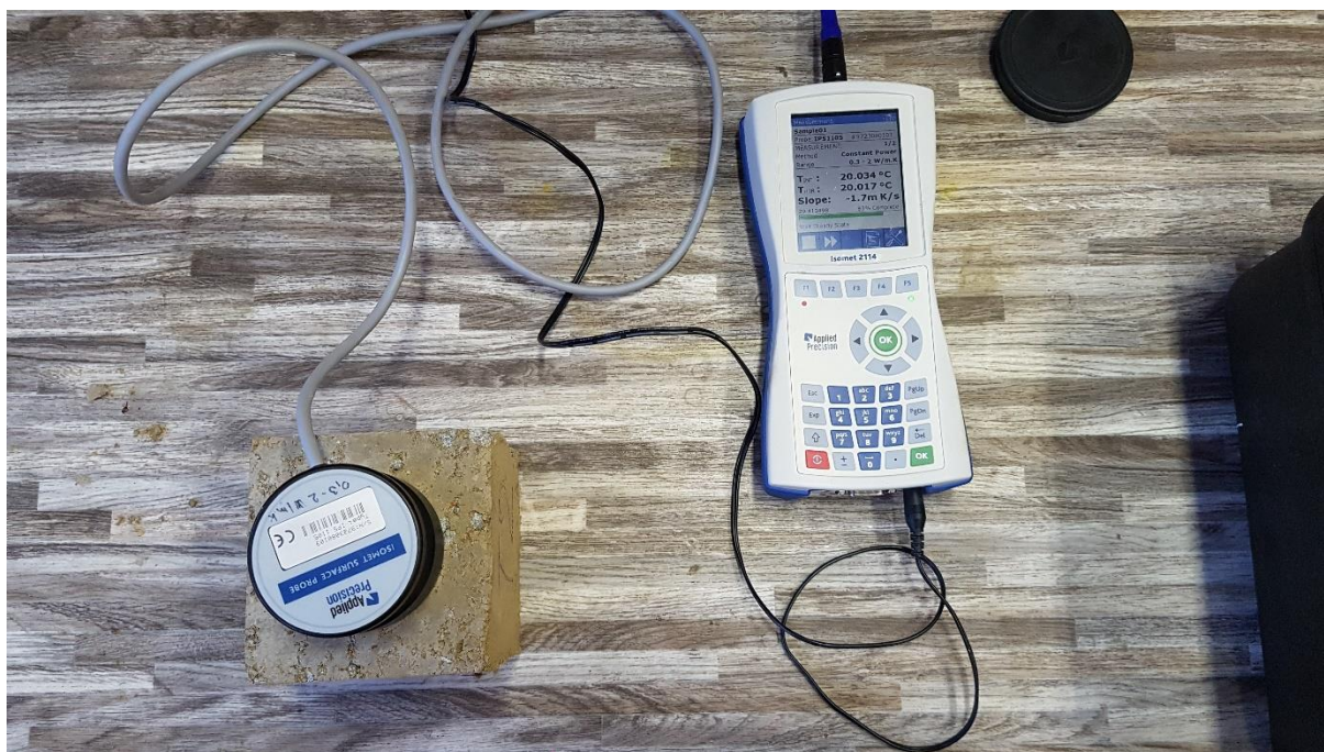
Obrázek 49: Měření součinitele tepelné vodivosti – \lambda pomocí přístroje ISOMET 2114
