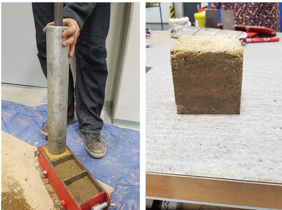
Obrázek 35: Dusání zkušeb. tělesa pomocí roznášecí desky (vlevo) a odformované zkušební těleso (vpravo)
