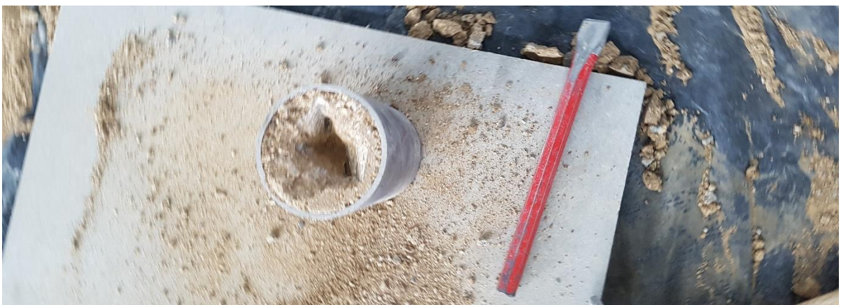
Obrázek 38: Příklad nezdařeného odformování zkušebního tělesa
