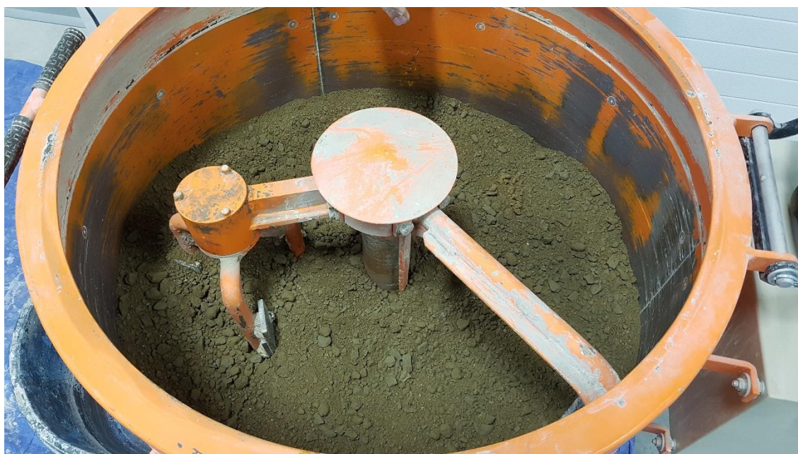
Obrázek 30: Míchání směsi ve vertikální kruhové míchačce s nuceným oběhem
