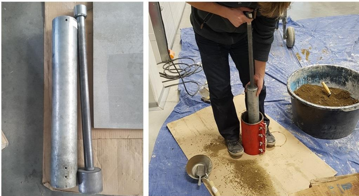
Obrázek 33: Proctoro dusadlo 4,5 kg (vlevo) a hutnění vrstvy ve formě válce 150×300 mm (vpravo)
