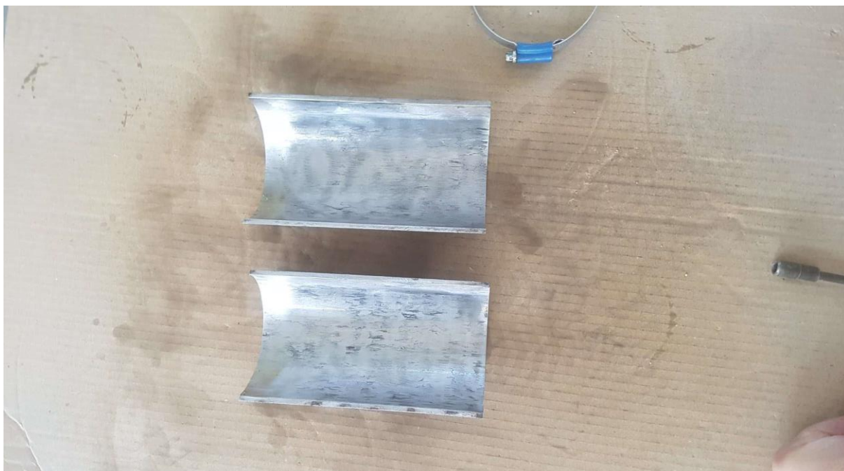
Obrázek 39: Příklad vyrobené nové formy pro zkušební těleso válec 80×160 mm
