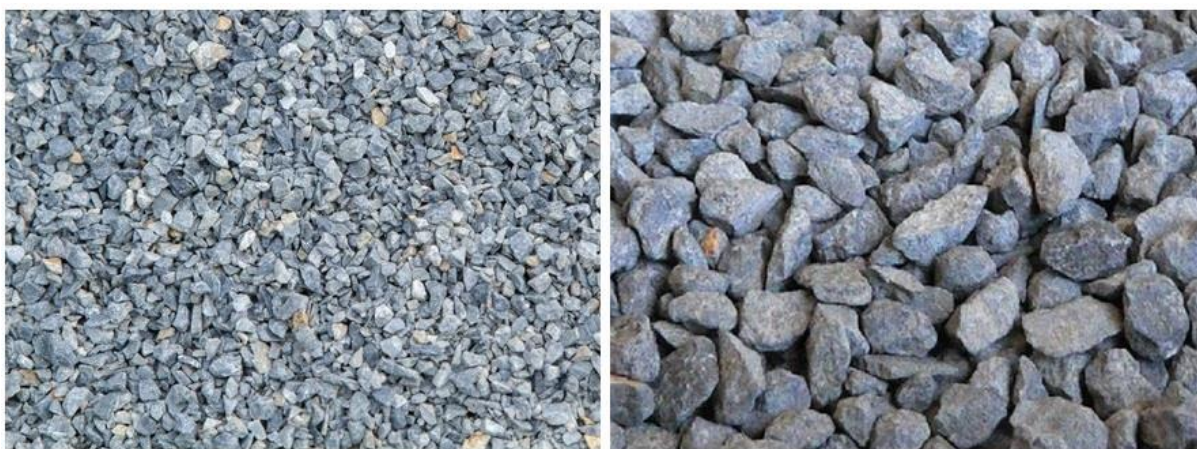
Obrázek 28: Štěrk frakce 4/8 mm (vlevo) a štěrk frakce 8/16 mm (vpravo)
