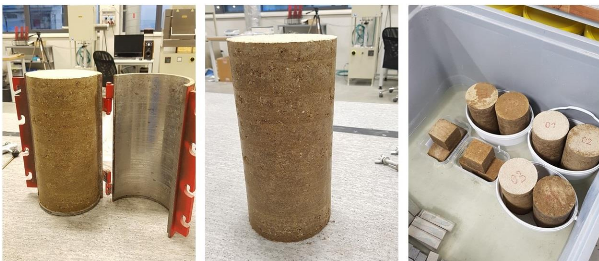
Obrázek 34: Odformování zkušebního tělesa (vlevo a uprostřed) a uložení zkušebních těles (vpravo)
