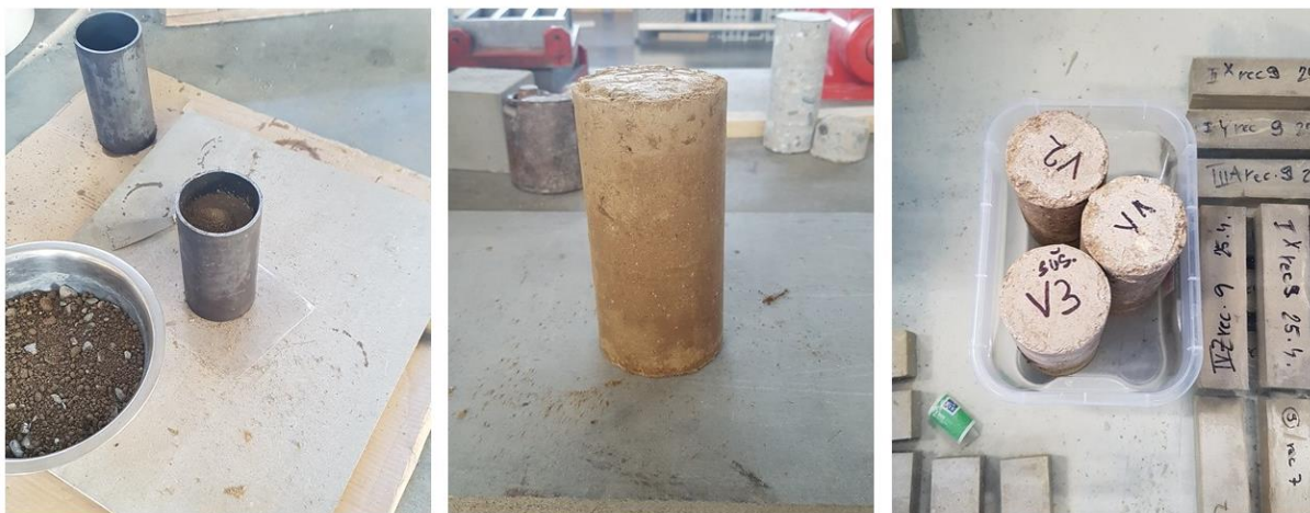
Obrázek 36: Výroba zkušebních těles (válec 80×160 mm) v rámci I. Etapy (vlevo), odformované zkušební těleso (uprostřed) a uložení zkušebních těles (vpravo)
