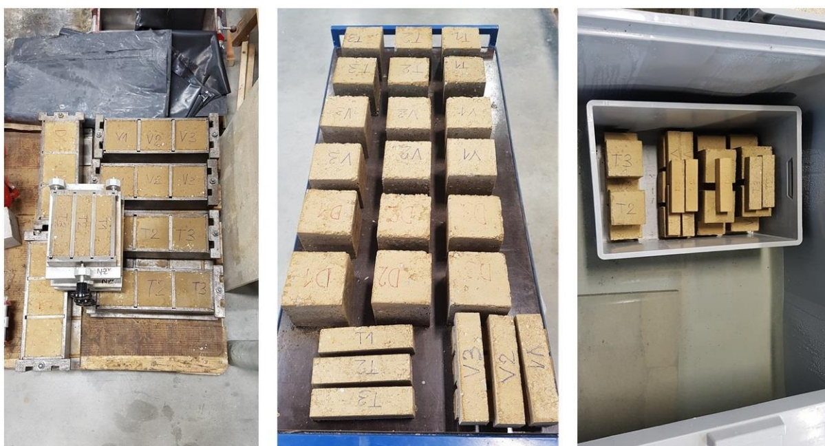
Obrázek 42: Vyrobená zkušební tělesa ve formách (vlevo), odformovaná zkušební tělesa (uprostřed) a uložení zkušebních těles (vpravo)
