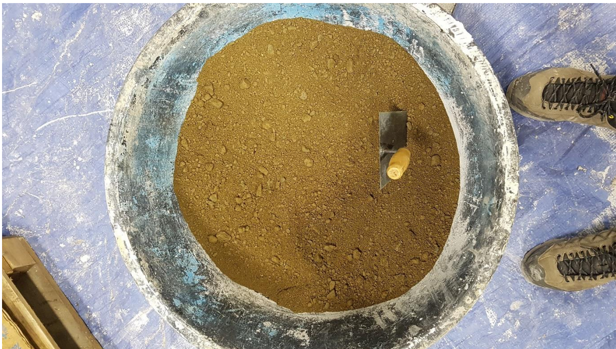
Obrázek 31: Hliněná směs po 10 minutách míchání
