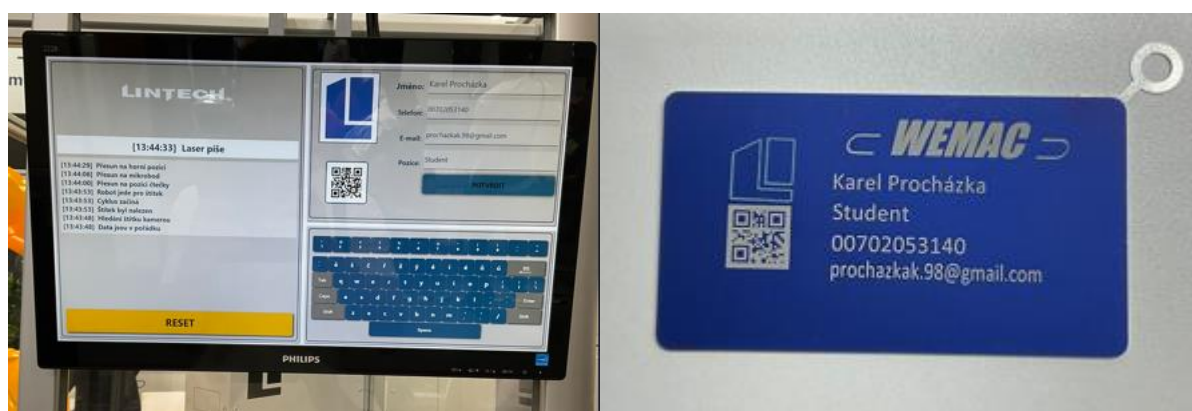
Obr. 90) Výsledná kovová vizitka vypálená laserem pomocí PR typu TX2-90 na robotickém pracovišti viz. výše (Autor: Karel Procházka)
