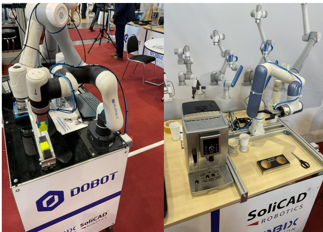
Obr. 97) Na fotografii vlevo je zachycen šestiosý kolaborativní robot typu Magician E6, určený pro výukové a lehké průmyslové aplikace, při manipulaci s barevně rozlišenými objekty pomocí dvoučelistového pneumatického koncového efektoru, vlevo se nachází kolaborativní robot Nova 2 určený k obsluze kávovaru v rámci ukázky zákaznické automatizace (Autor: Karel Procházka)
