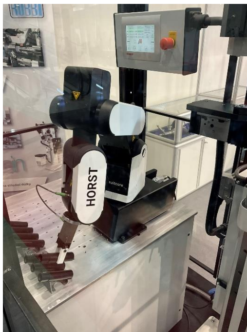
Obr. 102) PR typu HORST600 pro automatizovanou manipulaci s malorozměrovými dílci (Autor: Karel Procházka)
