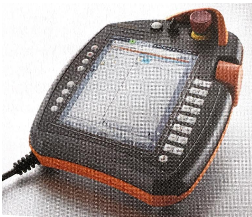
Obr. 25) Teach-pendant společnosti KUKA používaný pro on-line programování [2]
