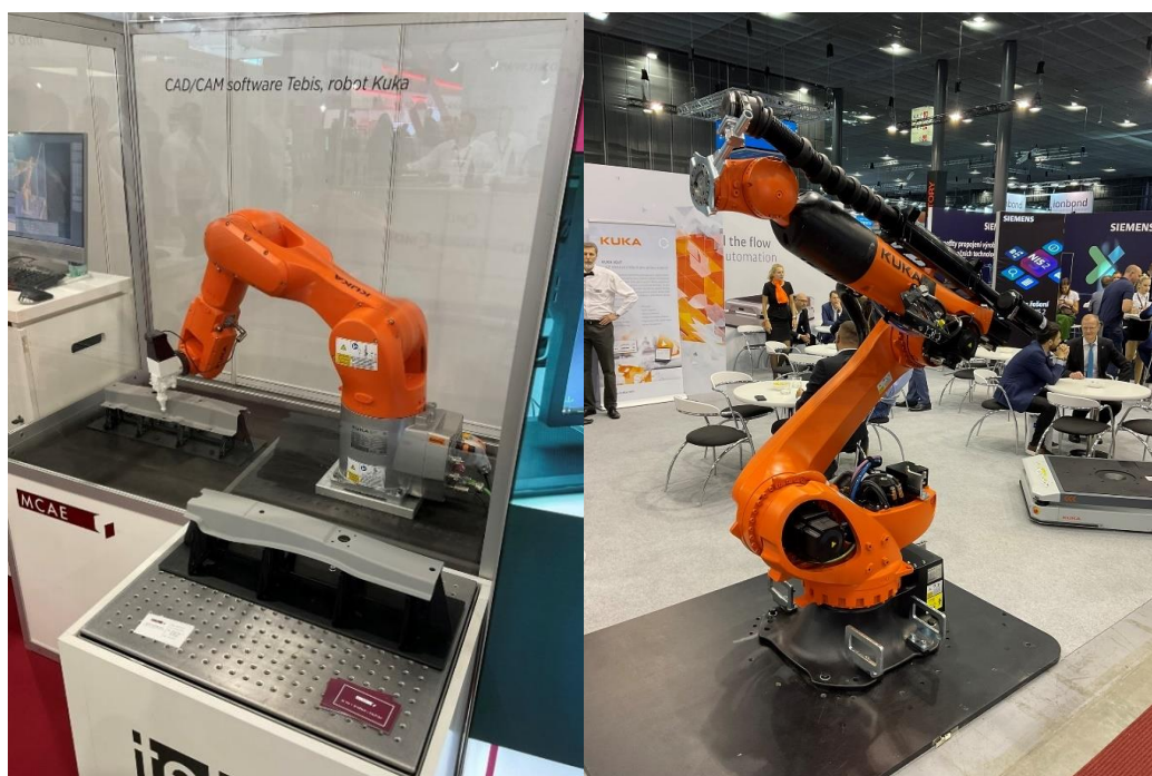
Obr. 83) Vlevo lze vidět PR typu KR 6 R700 AGILUS implementovaný do robotického pracoviště pro řezání laserem, vlevo se nachází robot KR QUANTEC (Autor: Karel Procházka)
