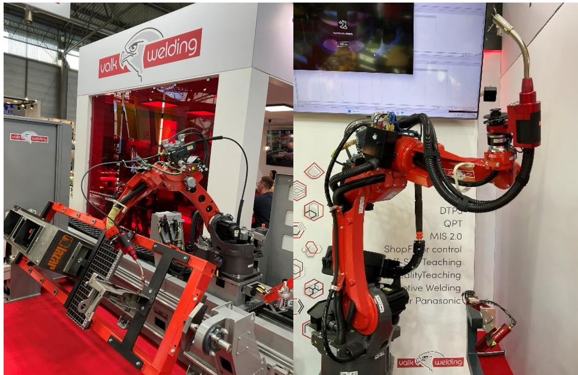
Obr. 94) Vlevo na fotografii se nachází univerzální robotický systém typu E-rám (automatizované svařovací pracoviště) s robotem TM 1400 WG3-350A integrovaný firmou Valk Welding, vpravo totožný robot samostatně (Autor: Karel Procházka)
