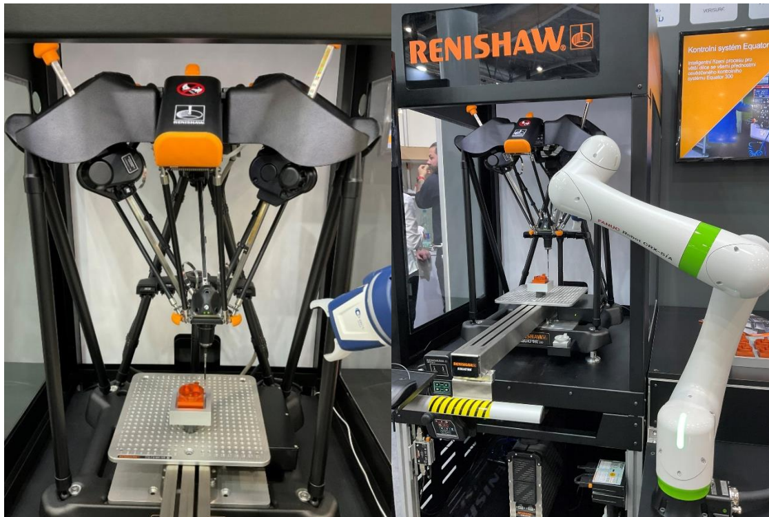
Obr. 108) Vlevo na obrázku se nachází delta robot EQUATOR 500 s měřicí sondou, vpravo ten samý robot v kooperaci s kolaborativním robotem CRX-5iA firmy FANUC pro manipulaci s měřenou součástí (Autor: Karel Procházka)
