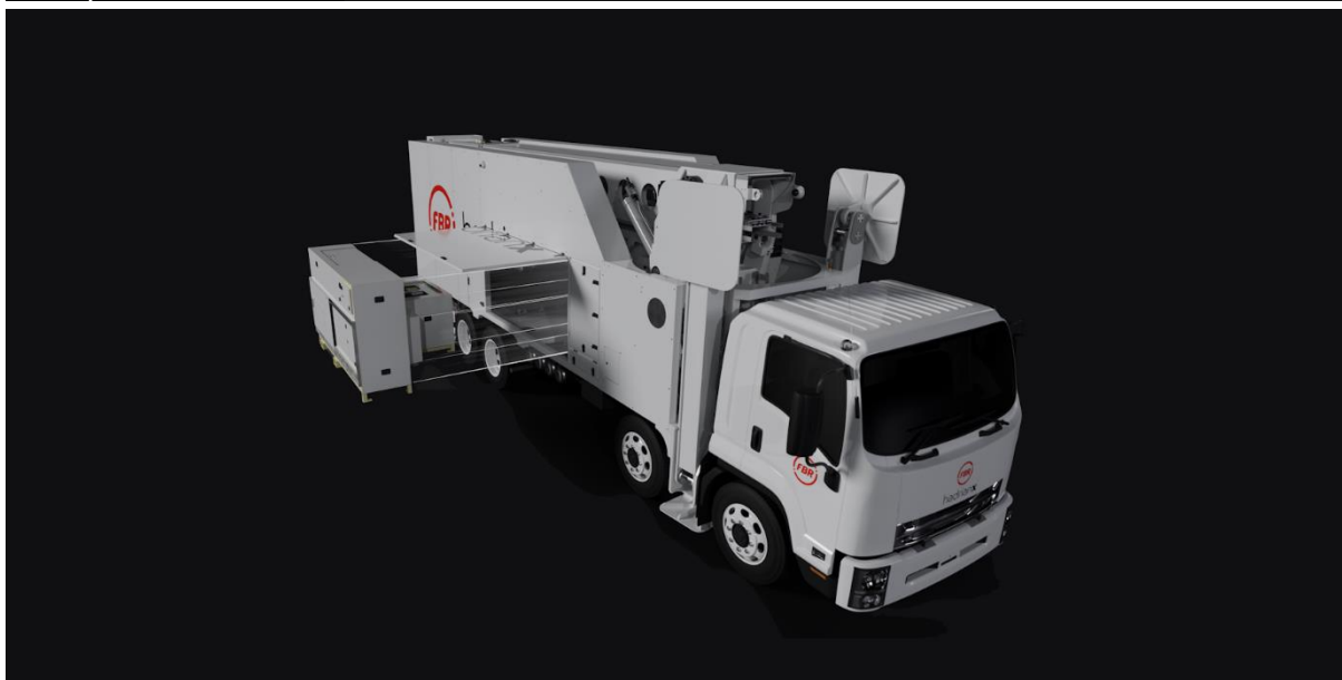
Obr. 38) Autonomní konstrukční rameno Next-Gen Hadrian X® společnosti FBR [36]
