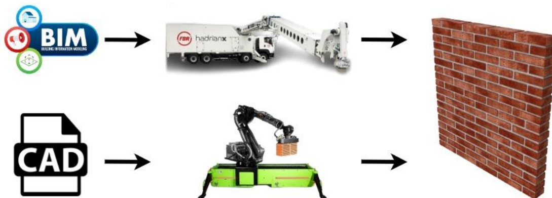
Obr. 58) Dva základní přístupy k řízení robotického zdění [64], [65], [66], [67], [68]
