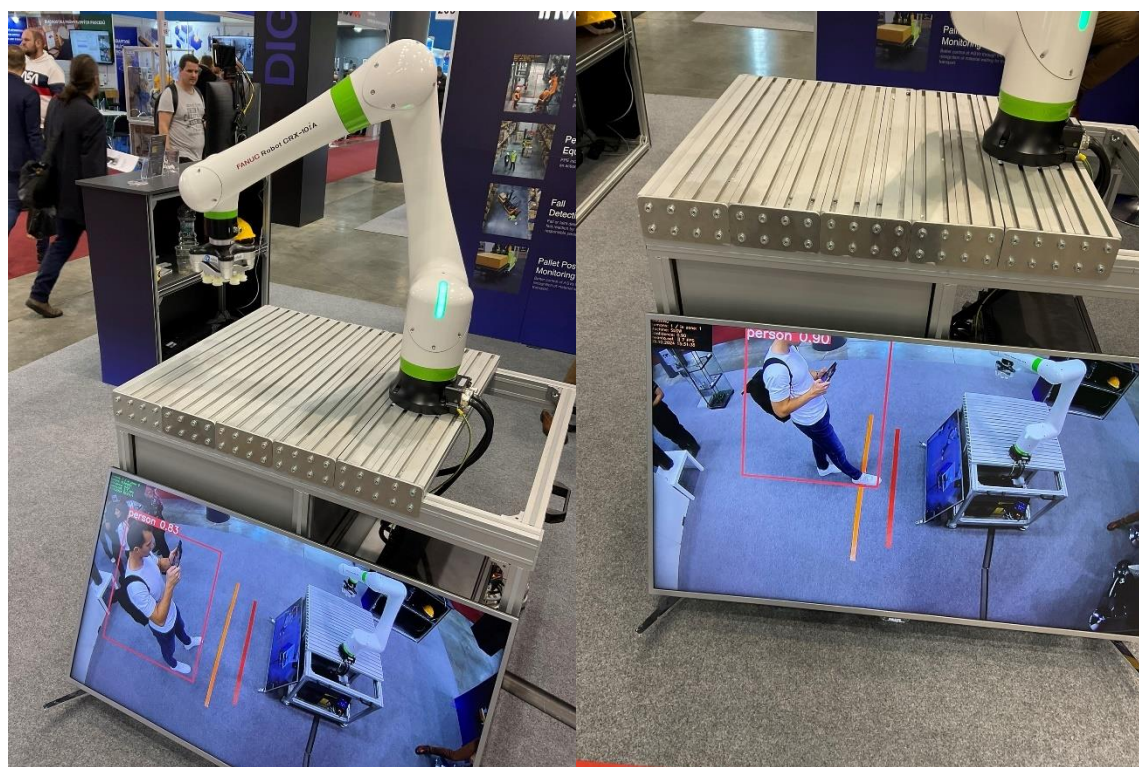
Obr. 67) Kolaborativní robot CRX-10iA vybaven bezpečnostní závorou (Autor: Karel Procházka)
