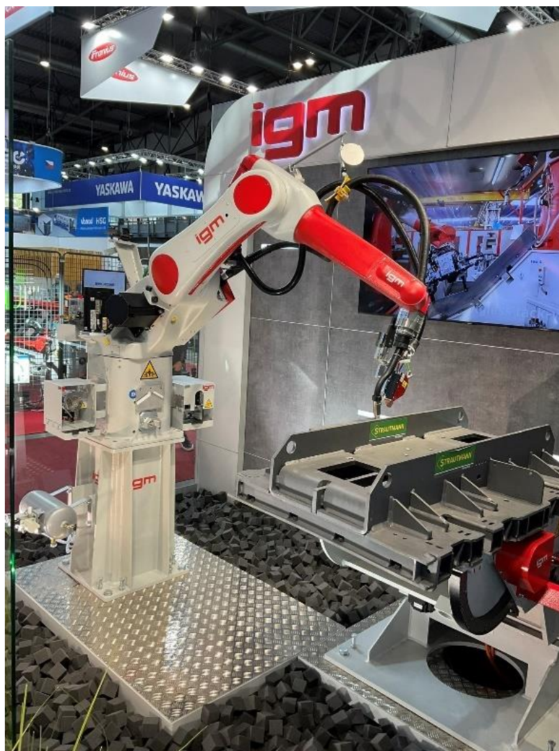
Obr. 103) Svařovací robot IGM RTE 400 s polohovadlem obrobku v automatizované buňce pro obloukové svařování (Autor: Karel Procházka)
