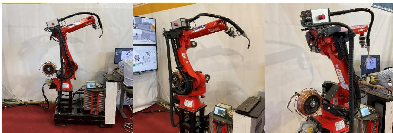
Obr. 92) Na všech třech fotografiích je zachycen PR typu SMART ARC, určený pro obloukové svařování metodou MIG/MAG a součástí jeho výbavy je svařovací hořák, podavač drátu a připojení ke svařovacímu zdroji (Autor: Karel Procházka)
