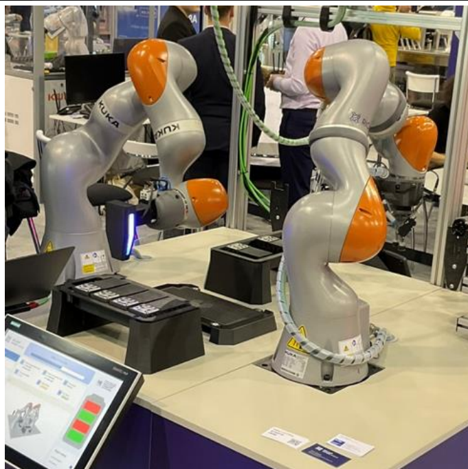
Obr. 85) Modulární robotická buňka kolaborativních robotů LBR iiwa 7 R800 na pracovišti (Autor: Karel Procházka)
