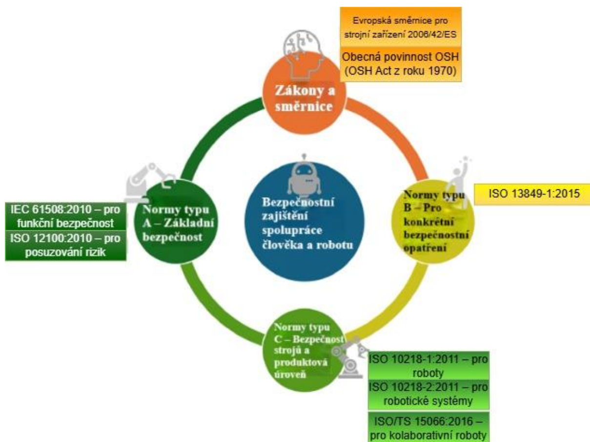
Obr. 36) Normy a předpisy pro zajištění bezpečnosti spolupráce člověka a stroje [1]
