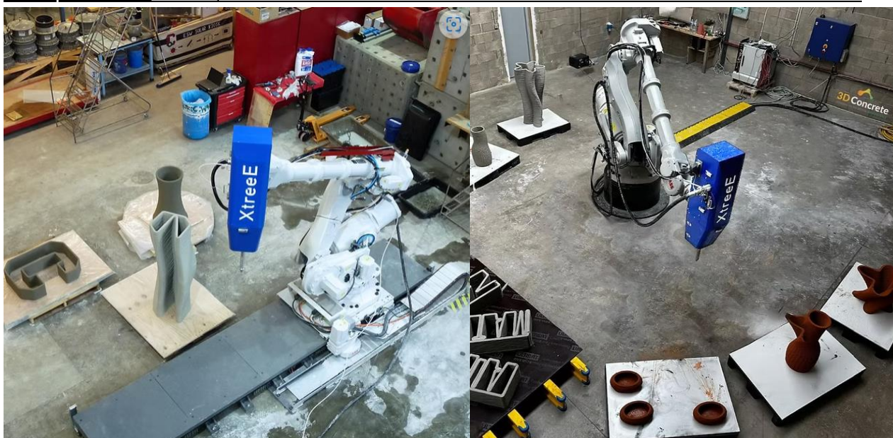
Obr. 52) Vlevo robotické rameno ABB na lineárním pojezdu a vpravo na statickém podstavci [56]
