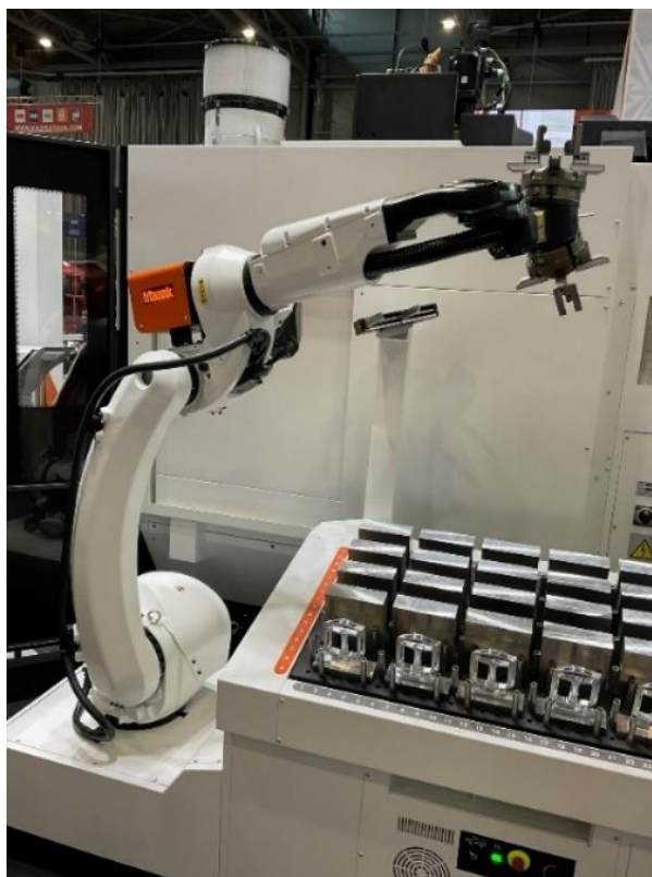
Obr. 75) PR typu M-20iD/25 (Food grade) integrovaný firmou MAZAK a určený pro manipulaci s obrobky nebo polotovary (Autor: Karel Procházka)
