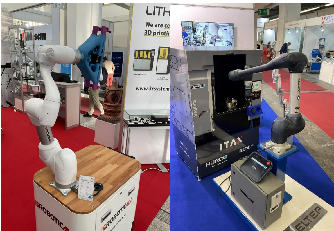
Obr. 95) Vlevo na fotografii se nachází kolaborativní robot řady M-Series v mobilním pracovišti ROBOTICALL pro manipulaci s 3D tištěnými díly, dále vpravo lze vidět robotické pracoviště pro automatizovanou obsluhu CNC stroje, obsluhované kolaborativním robotem řady M-Series, vybaveným dvourstým elektrickým chapadlem OnRobot, kdy toto řešení je realizováno firmou ELTEP ve spolupráci se společnostmi ITAX a HURCO, a představuje pokročilou integraci robotizace ve strojírenské výrobě v souladu s principy Průmyslu 4.0 (Autor: Karel Procházka)
