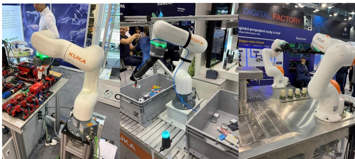
Obr. 84) Na prvních dvou snímcích zleva jsou zobrazeny kolaborativní roboty LBR iiwa 3 R760 s dvoučelistovým pákovým chapadlem a podtlakovým efektozem pro manipulaci s drobnými předměty. Vpravo je vidět verze LBR iiwa 8 R930 určená k uchopení plastových kelímků, jejich naplnění pivem a předání uživateli (Autor: Karel Procházka)
