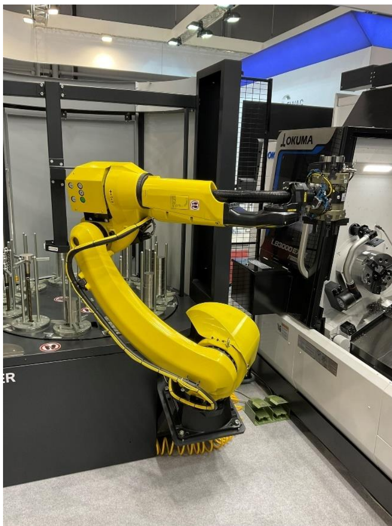
Obr. 76) CNC obráběcí centrum osazené PR z řady M-20 určeným pro manipulaci s obrobky nebo polotovary (Autor: Karel Procházka)
