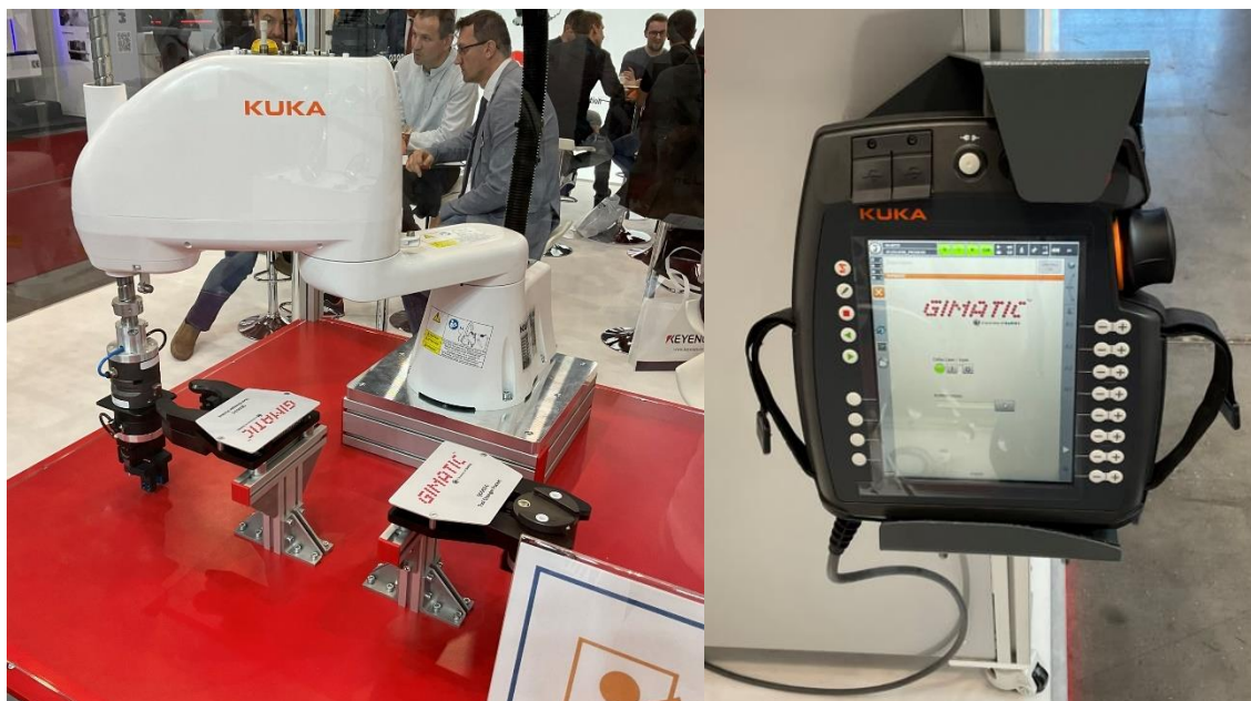
Obr. 82) Robot typu SCARA KR 6 R500 Z200 včetně pendantu pro ovládání robotu (Autor: Karel Procházka)
