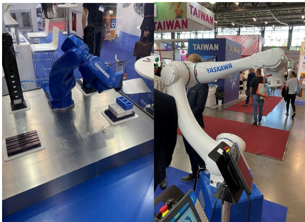
Obr. 77) Vlevo šestiosý vertikální kloubový robot MotoMINI, vpravo kolaborativní robot HC20DTP (Autor: Karel Procházka)
