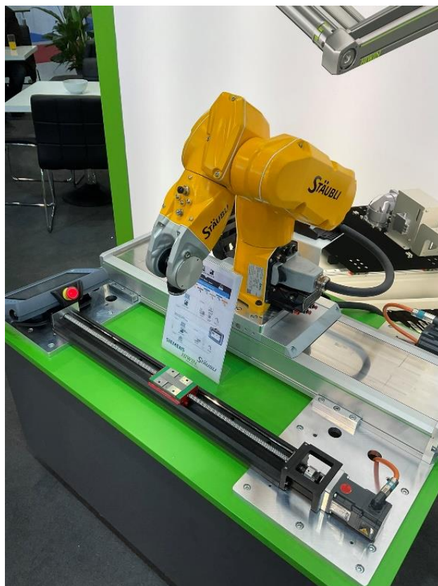
Obr. 91) PR typu TX2-40 umístěn na lineární ose HT-S firmy HIWIN poháněné kuličkovým šroubem, před robotem je dále umístěna lineární osa KK typ F (Autor: Karel Procházka)
