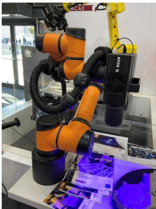
Obr. 106) Kolaborativní robot řady AUBO-i v kombinaci s 3D optickým skenerem ATOS Q (Autor: Karel Procházka)
