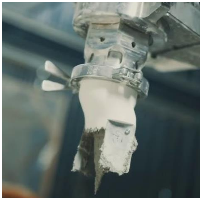
Obr. 60) Tisková hlavy 3D tiskárny BOD2 společnosti COBOD [70]
