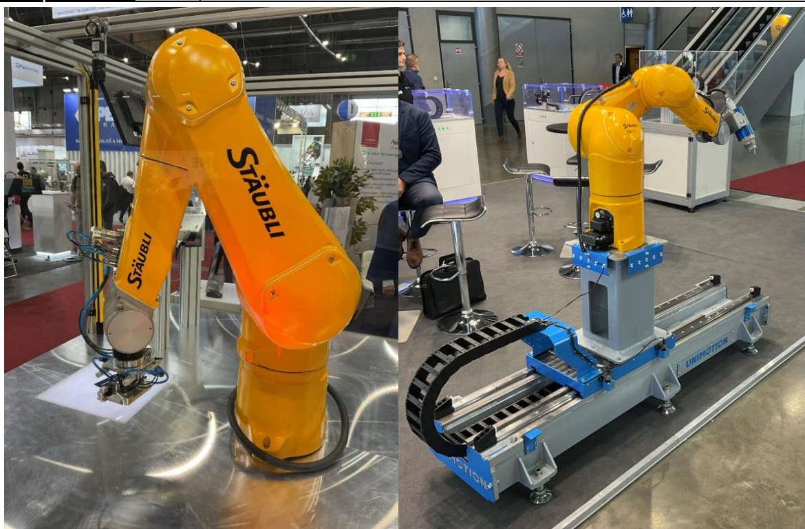
Obr. 89) PR typu TX2-90, vlevo robotické pracoviště pro výrobu kovových vizitek, vpravo robot na lineárním pojezdu firmy Unimotion využívajícím hřebenového převodu a pastorku (Autor: Karel Procházka)
