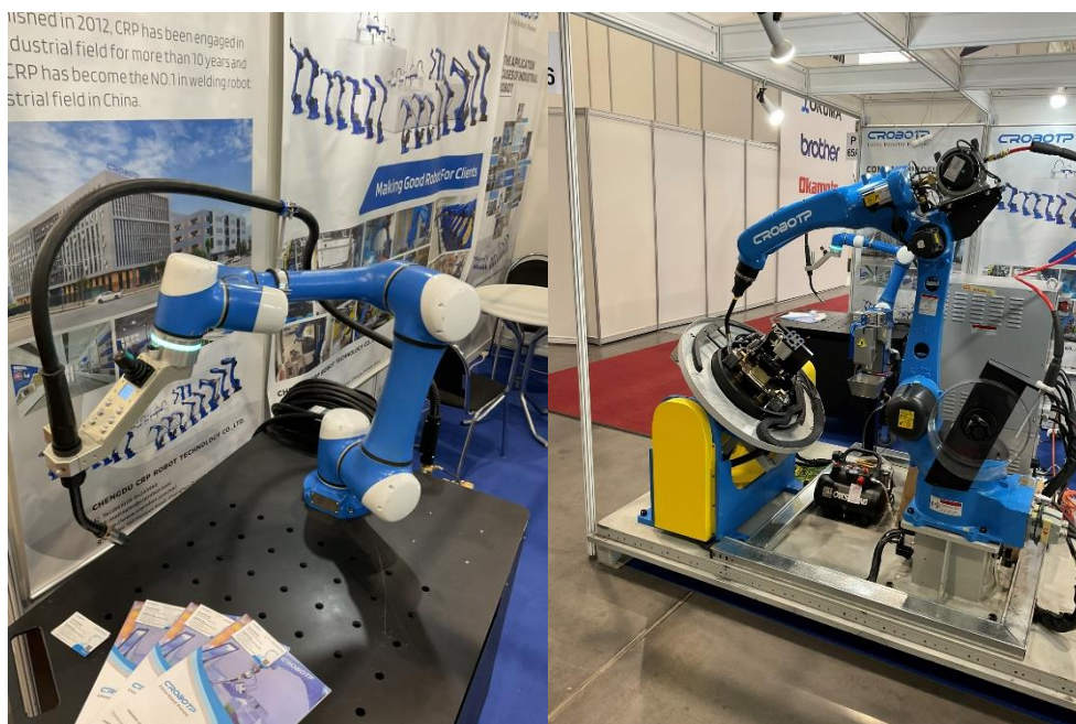
Obr. 101) Vlevo lze pozorovat kolaborativní svařovací robot CRP-RC09-05 pro přesné obloukové svařování, vpravo pak svařovací robot CRP-RH14-10-W s rotačním polohovadlem pro přesnou víceosou manipulaci (Autor: Karel Procházka)
