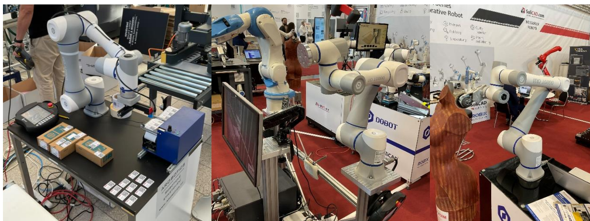
Obr. 96) Úplně vlevo lze pozorovat automatizované pracoviště s kolaborativním robotem CR5 pro manipulaci a aplikaci etiket v rámci balicí linky, dále pak uprostřed obrázku lze vidět kolaborativní robot CR7 s univerzální montážní přírubou pro koncový efektor na konci ramene robotu, a posledně na obrázku vpravo se nachází kolaborativní robot CR10 při demonstraci broušení dřevěného torza těla (Autor: Karel Procházka)
