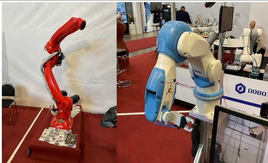
Obr. 93) Na fotografii vlevo je zachycen kolaborativní robot z řady S-Family určený pro nasazení v automatizačních procesech, zejména v oblastech manipulace, svařování či montáže, vpravo lze pak pozorovat kolaborativní robot typu Racer5 COBOT, vybaven pneumatickým dvoučelistovým paralelním chápadlem pro standardní manipulace s menšími díly (Autor: Karel Procházka)
