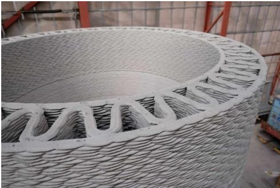
Obr. 45) 3D vytištěný základ větrné turbíny ve spolupráci s firmami Holcim a GE Renewable Energy [43]
