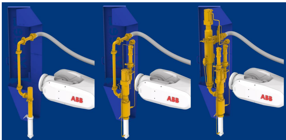
Obr. 51) Na obrázku jsou znázorněna schémata tři základních tiskových hlav, zleva 1K, 2K, 3K+ [55]
