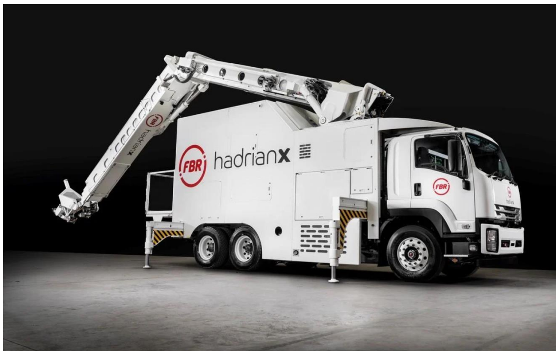
Obr. 37) Autonomní konstrukční rameno Hadrian X® společnosti FBR [34]
