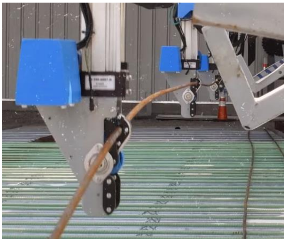
Obr. 61) Uchopovací systém portálového PR IronBOT [60]
