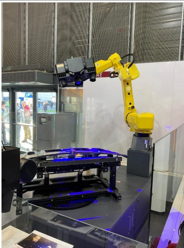
Obr. 74) Kloubový robot M20iA v kombinaci se skenerem ATOS 5 snímající plechový výrobek (Autor: Karel Procházka)
