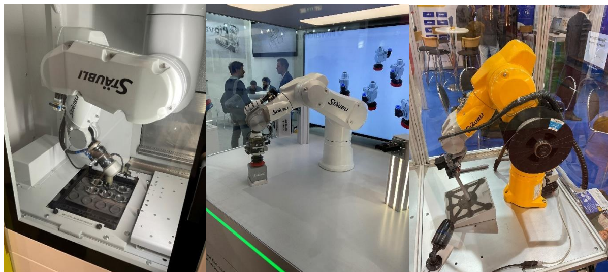
Obr. 88) PR typu TX2-60, vlevo manipulace s pouzdry hodinek tříčelistovým koncovým efektem, uprostřed je využit podtlakový koncový efektor a vpravo robot optimalizovaný pro 3D tisk (Autor: Karel Procházka)
