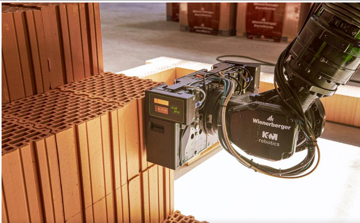
Obr. 40) Pohled na koncový efektor (griper) zdícího robotu WLTR [88]
