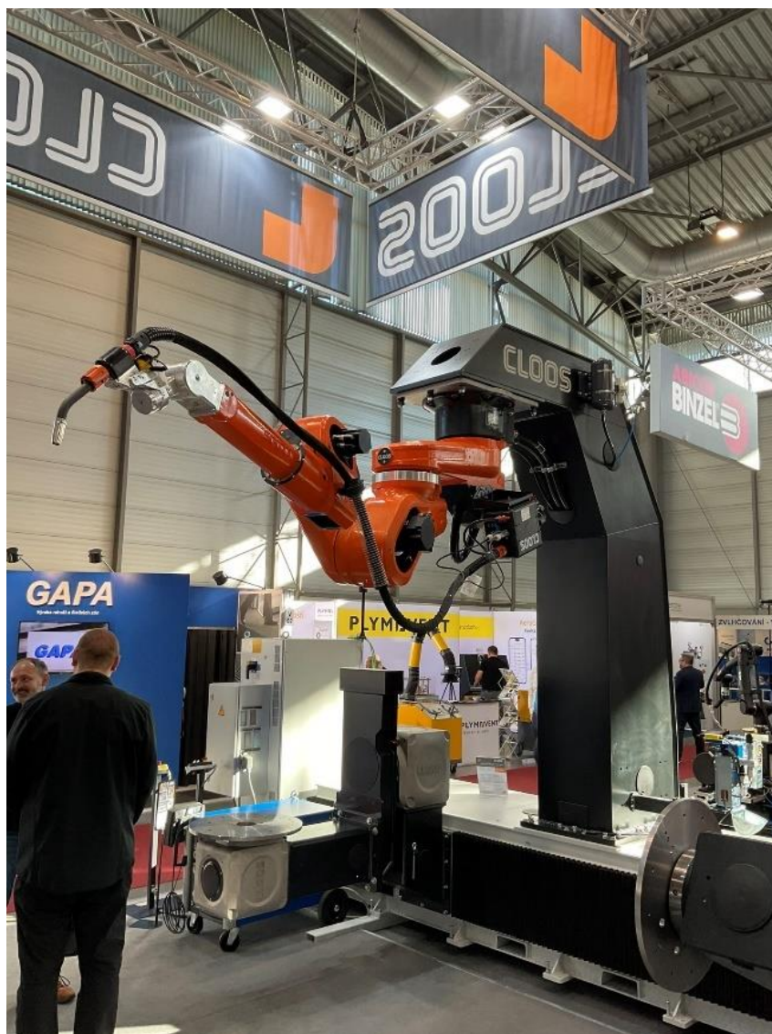
Obr. 98) Svařovací robot QIROX od společnosti CLOOS integrovaný do portálového systému (Autor: Karel Procházka)
