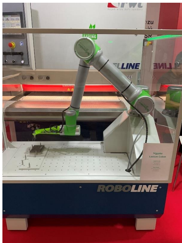
Obr. 104) Robotické pracoviště ROBOLINE osazené kolaborativním robotem Lexium Cobot (Autor: Karel Procházka)
