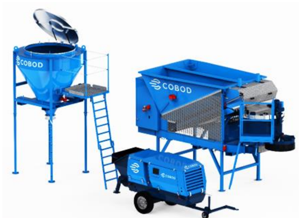
Obr. 49) Vlevo se nachází silo pro skladování suchého cementu, uprostřed dvouválcové hydraulické pístové čerpadlo a vpravo dávkovací zařízení směsi [50]
