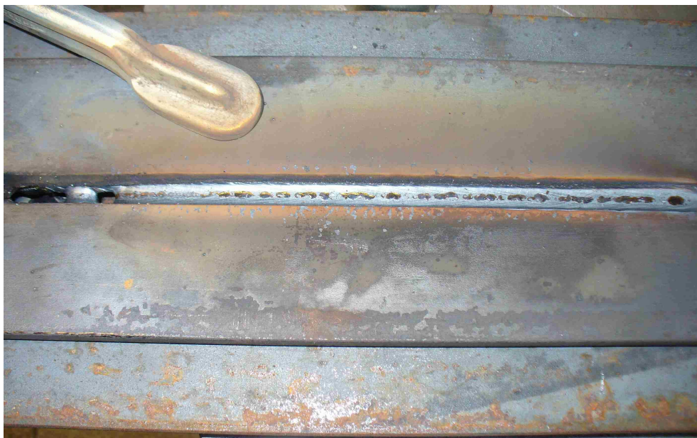
Obr. 5.7 Svar při zvýšené rychlosti podávání drátu
