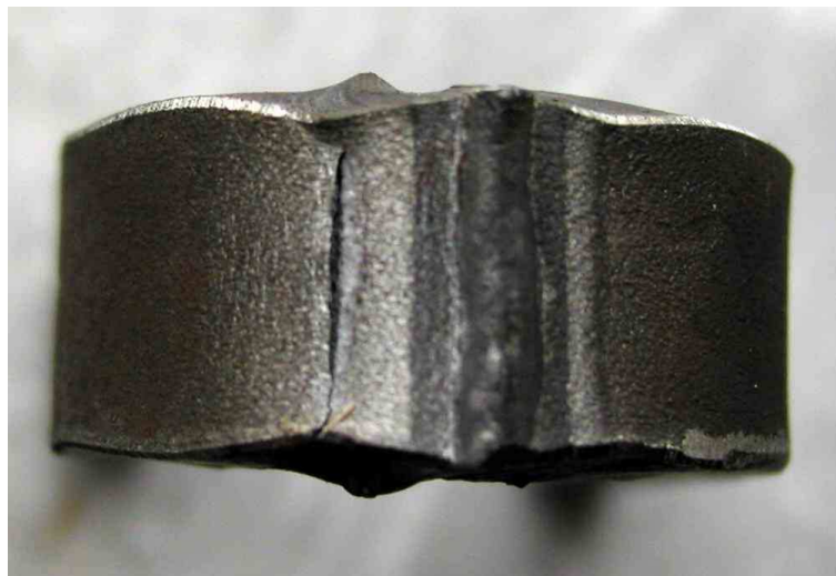
Obr. 5.14 Pohled na ohyb v oblasti kořene o úhlu 150^\circ
