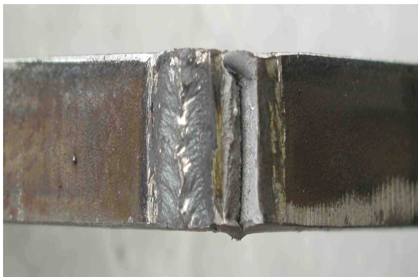
Obr. 5.13 Pohled na trhlinu v TOO při ohybové zkoušce na povrchu svaru
