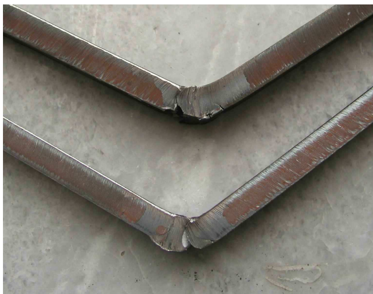
Obr. 5.16 Vzorky ohýbané na straně svaru
