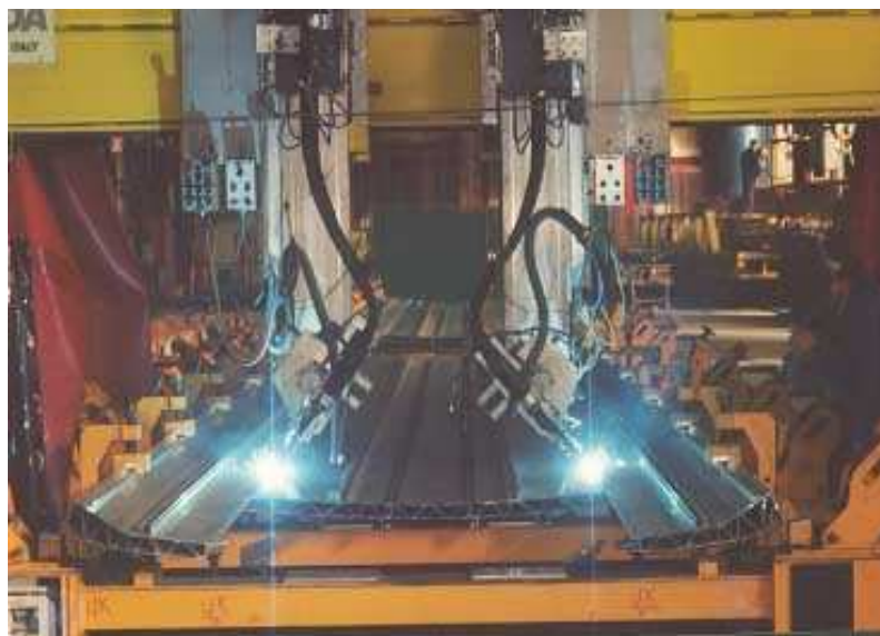
Obr. 2.17 Svařování kolejových vozidel 11
