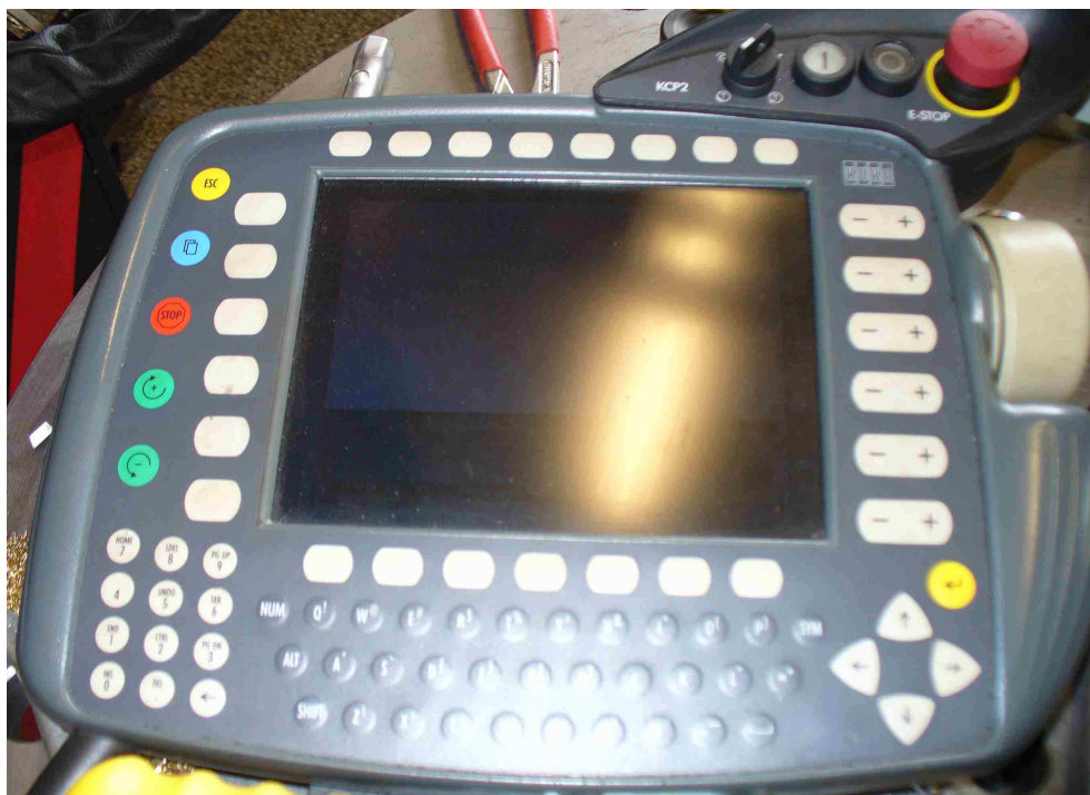
Obr.5.9 Digitální displej pro nastavení polohy svařování
