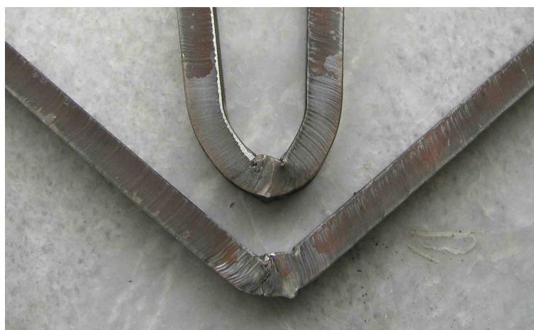
Obr. 5.15 Vzorky ohýbané na straně kořene
