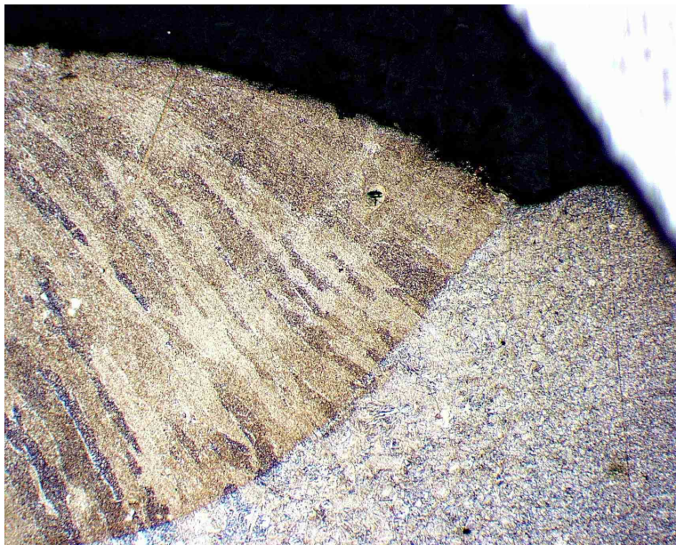
Obr.5.30 Přejchod povrchu svarového kovu, do základního materiálu zvětšeno 50x
