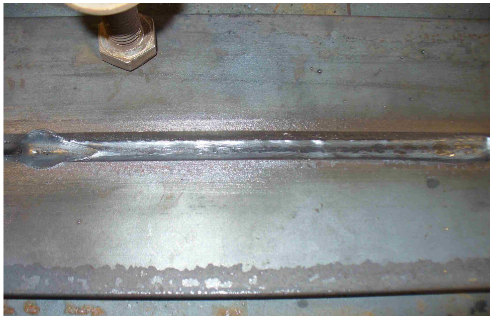
Obr. 5.6 První svar na zkušebním vzorku z uhlíkové oceli
