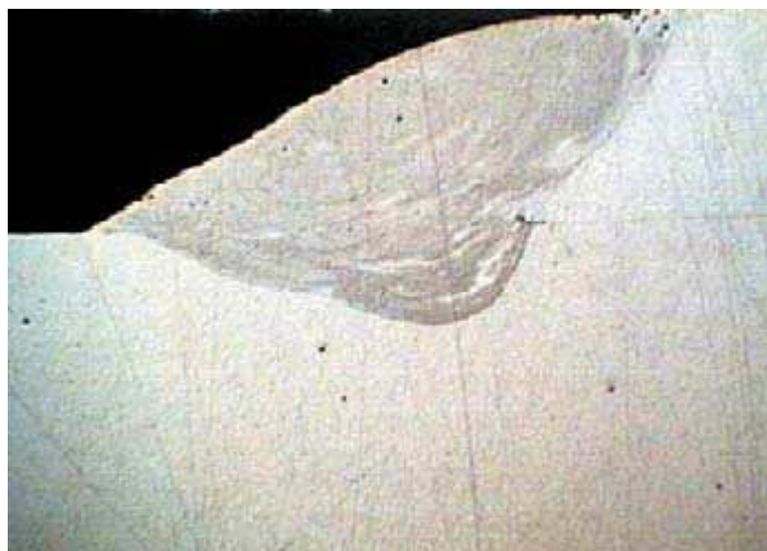
Obr. 2.9 Pohled na svar provedený hybridním procesem Laser-MIG a jeho příčný makrovýbrus 5
