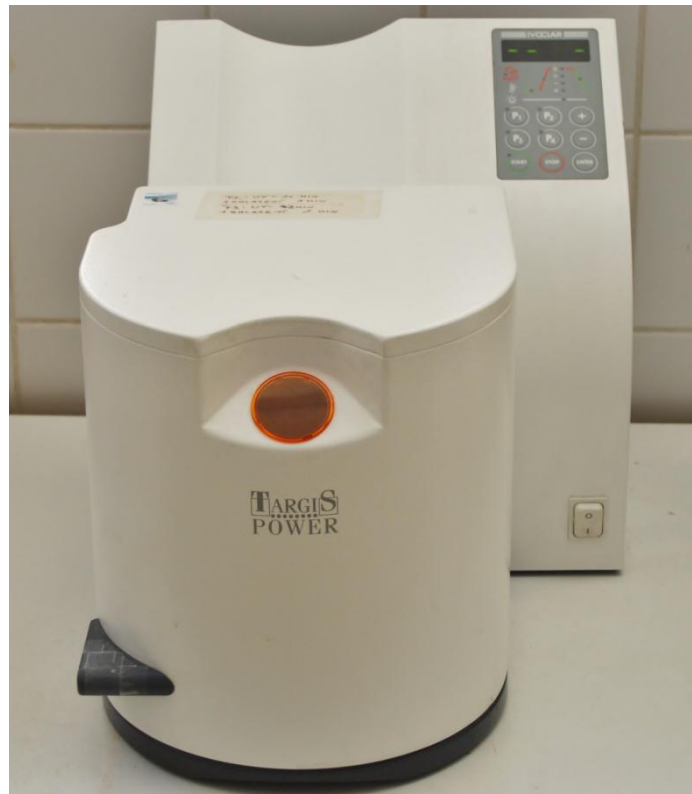
Obr. 12: Komora pro vytvrzování světlem Targis Power (Ivoclar)
