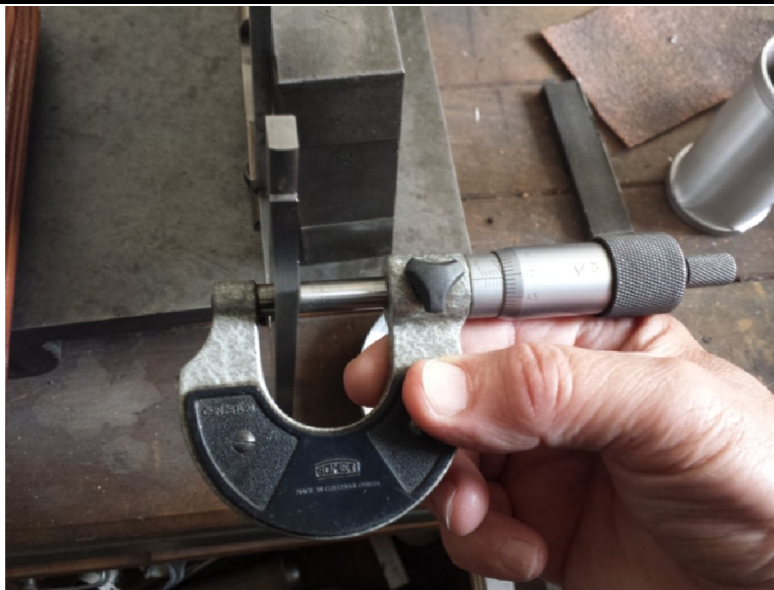
Obr. 3.3 – Měření pevného ramena analogového dílenského posuvného měřidla
