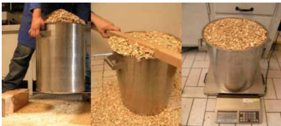
Obr 3.1: Postup při stanovování sypné hmotnosti; převzato z [21]
