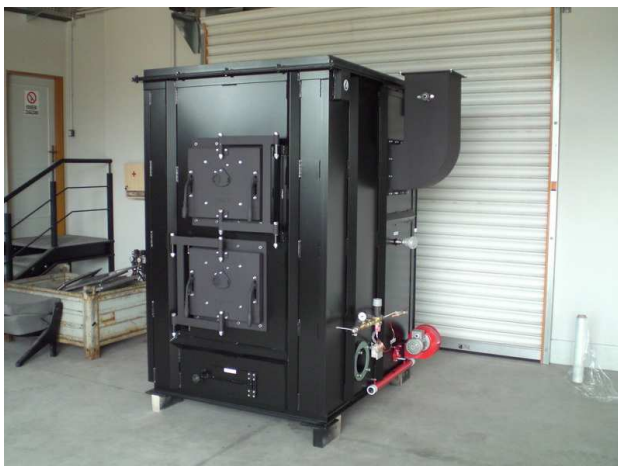
Obr. 5.1: Horkovzdušný kotel Fiedler; převzato z [21]
