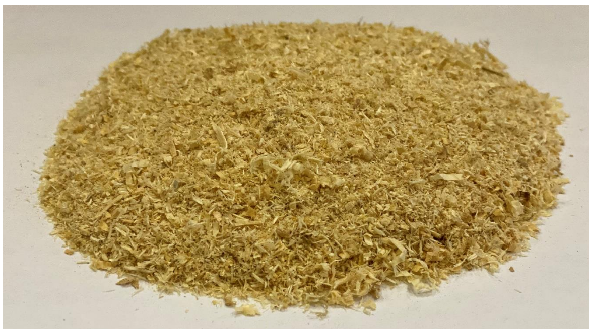
Obrázek 22: Piliny použité jako plnivo do vyvijených lepicích hmot
