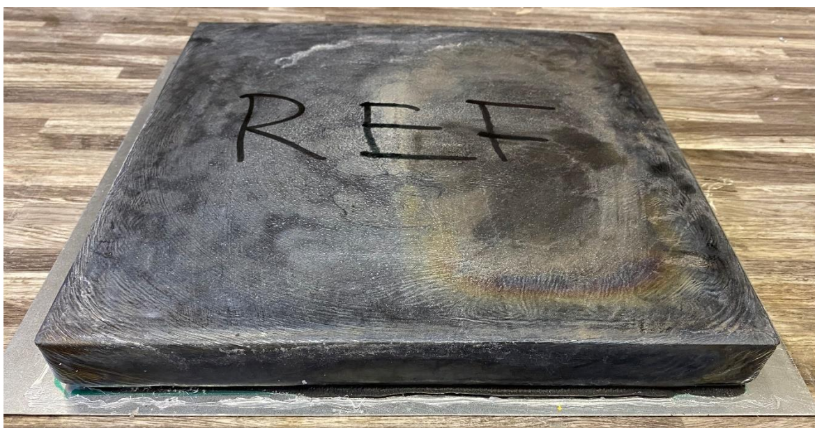
Obrázek 50: Aplikace lepící hmoty v praxi – referenční vzorek EP 1 FLEX, plnivo vápenec 60 %, tloušťka lepící hmoty 5 mm
