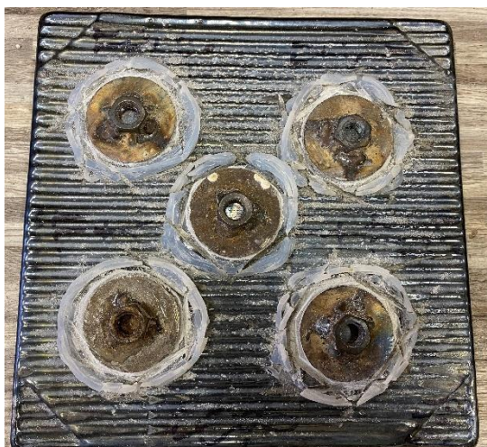
Obrázek 40: Příprava vzorků pro odtrh
