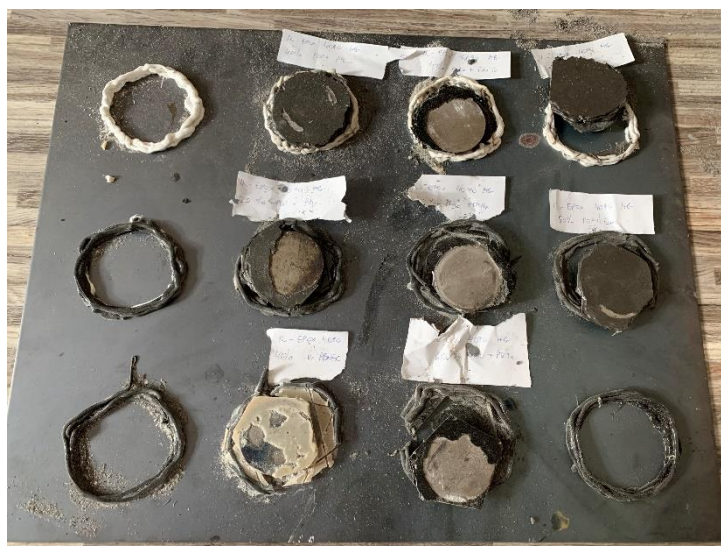
Obrázek 30: Zkoušené lepící hmoty po stanovení tahové přídržnosti na plechovou desku, s porušením v podkladu
