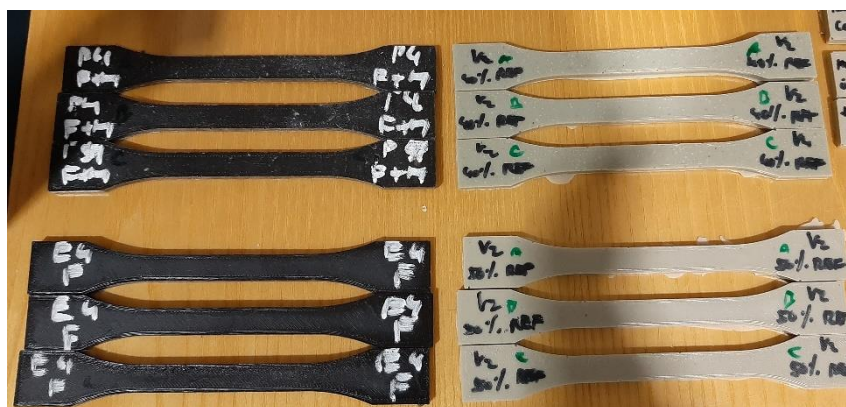
Obrázek 43: Vzorky pro stanovení tahových vlastností (typ IBA)
