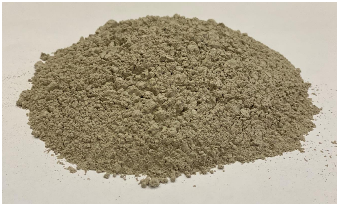
Obrázek 19: Vápenec použitý jako primární plnivo do lepicích hmot
