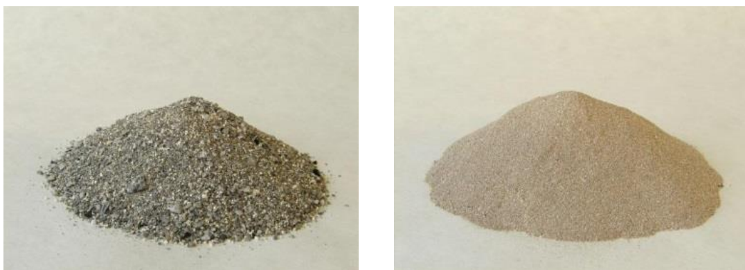
Obrázek 17: Fluidní ložový popel (vlevo) a fluidní filtrový popílek (vpravo) [32]
