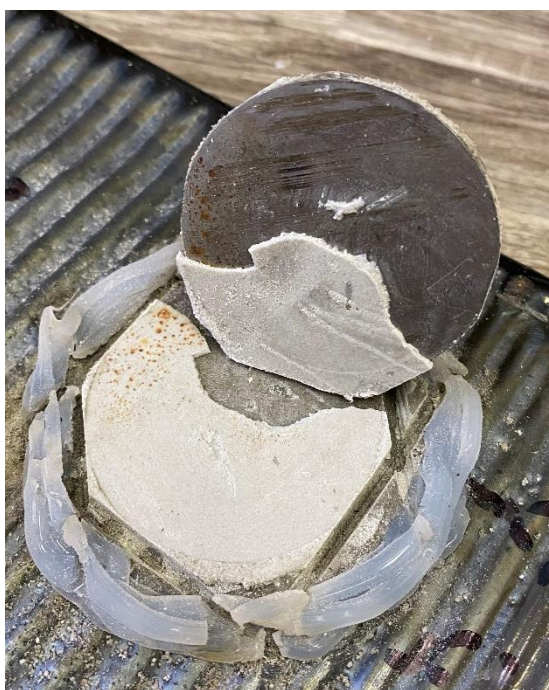
Obrázek 42: Porušení vzorku v lepidle Sikadur při zkoušení přídržnosti
