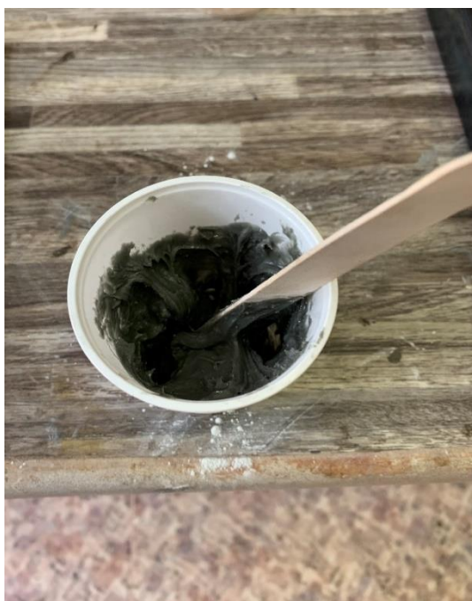
Obrázek 25: Příprava lepící hmoty-receptura z primárních surovin-epoxid EP 1 FLEX-mastek (60 %)
