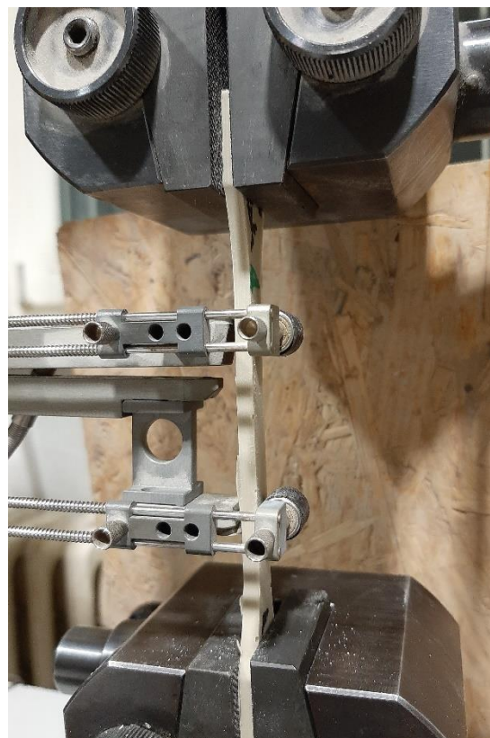
Obrázek 44: Stanovení pevnosti v tahu (zkušební tělesa opatřená extenzometrem)
