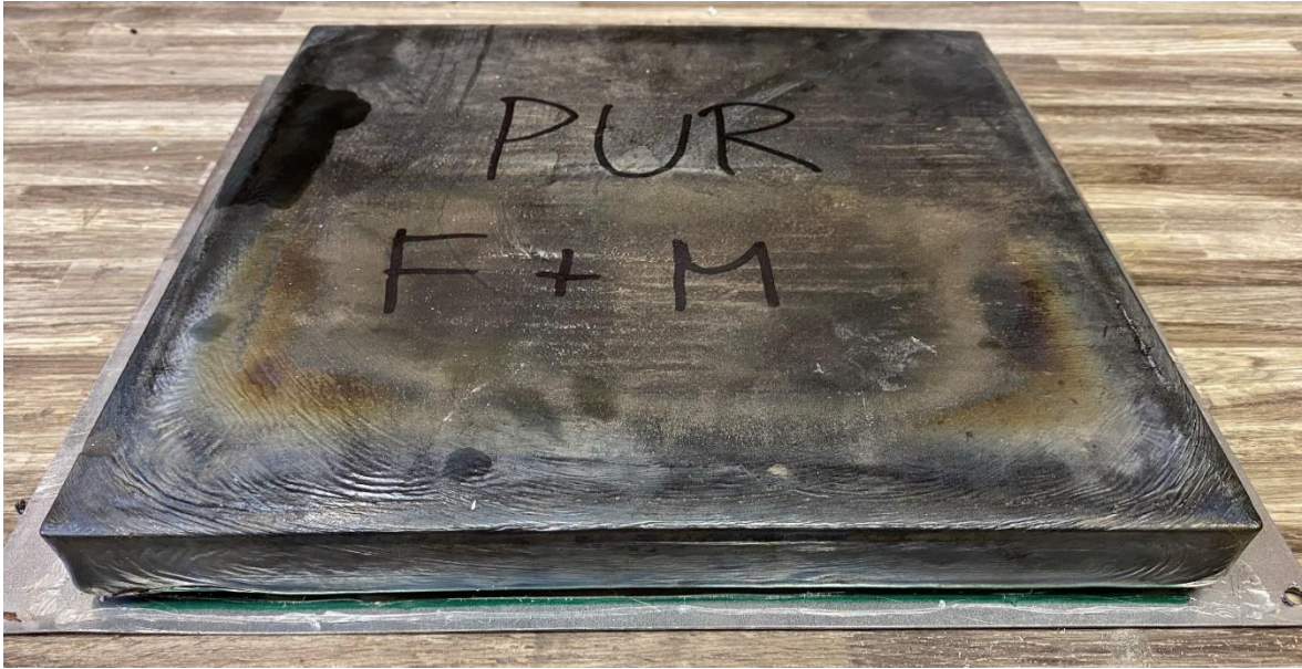
Obrázek 52: Aplikace lepicí hmoty v praxi–referenční vzorek PUR 1, plnivo čedičové odkapy+mastek 40 %, tloušťka lepicí hmoty 5 mm
