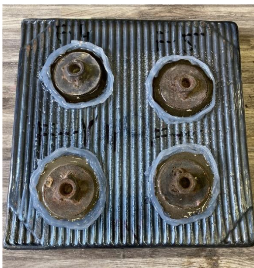
Obrázek 27: Aplikace lepicí hmoty PUR 1 a terče—čedičová dlažba-terče
