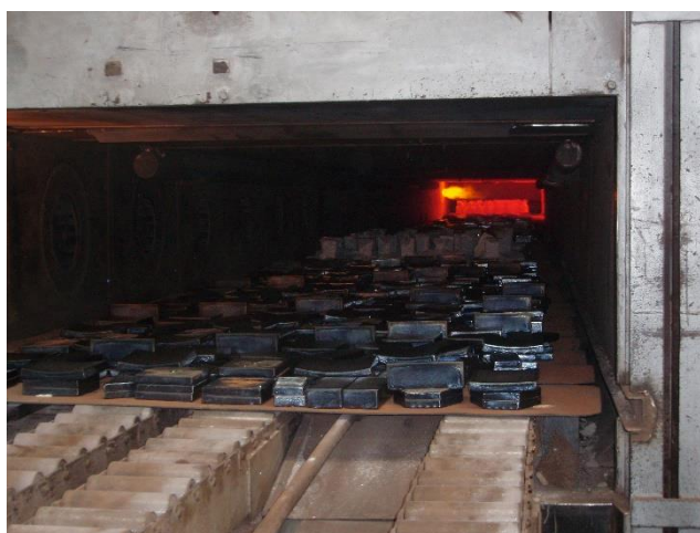
Obrázek 5: Chlazení výrobků v tunelové peci – konec ochlazovacího procesu [13]
