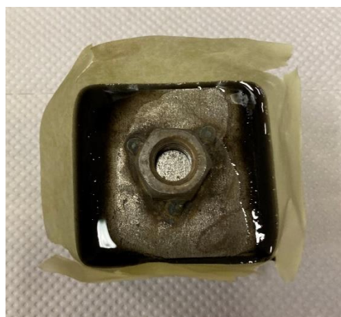
Obrázek 33: Příprava vzorků pro chemicky náročné prostředí vlevo: vzorek připravený pro aplikaci lepicí hmoty vpravo: vzorek po aplikaci lepicí hmoty EP 1 FLEX a terče
