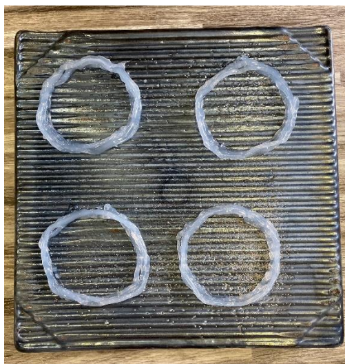
Obrázek 26: Čedičová dlažba připravena na aplikaci lepicí hmoty pro stanovení tahové přídržnosti
