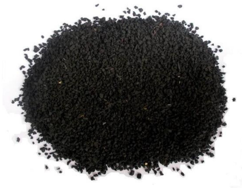
Obrázek 14: Granulát z pneumatik frakce 1 – 3 mm [28]
