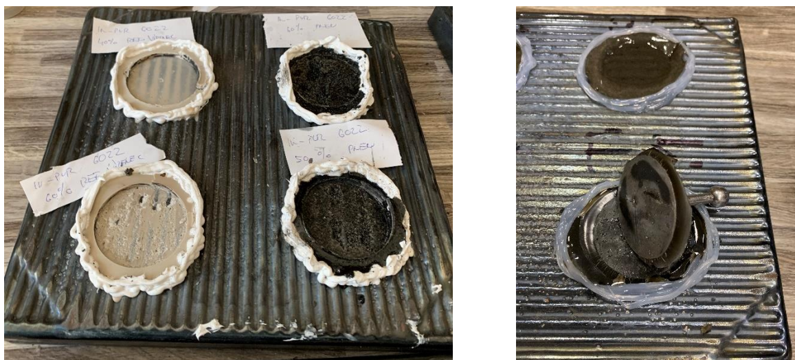
Obrázek 29: Zkoušené lepící hmoty po stanovení tahové přídržnosti na čedičové dlažbě, receptura PUR 1 vápenc (vlevo) a obrus z pneumatik (vpravo)
