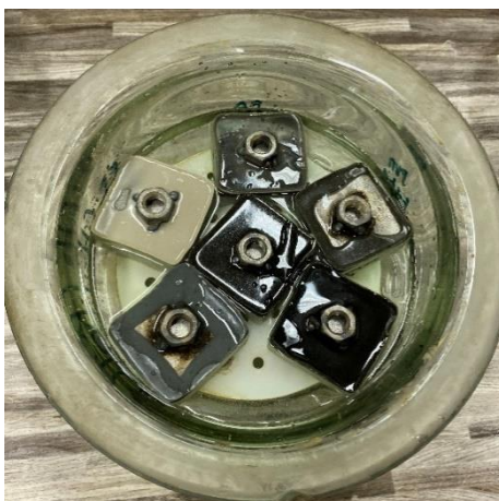
Obrázek 34: Uložení vzorků v chemicky agresivním prostředí H_2SO_4 (v exsikátoru), EP 1 FLEX
