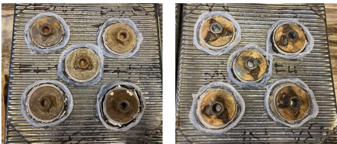
Obrázek 39: Vzorky připravené pro stanovení tahové přídržnosti po náročném tepelném prostředí
