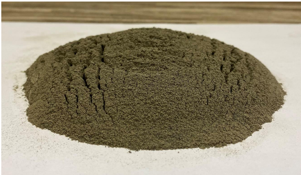
Obrázek 24: Pomleté čedičové odkapy použité jako plnivo do vyvíjených lepicích hmot
