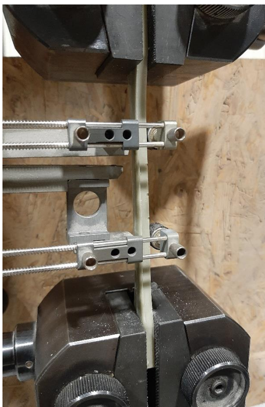
Obrázek 44: Stanovení pevnosti v tahu (zkušební tělesa opatřená extenzometrem)
