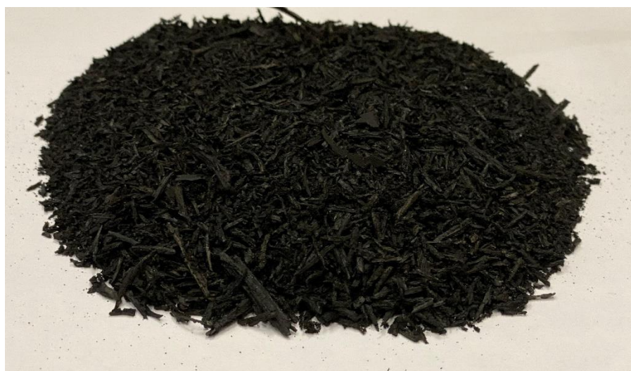
Obrázek 23: Obrus z pneumatik frakce 1 – 10 mm použitý jako plnivo do vyvíjených lepících hmot
