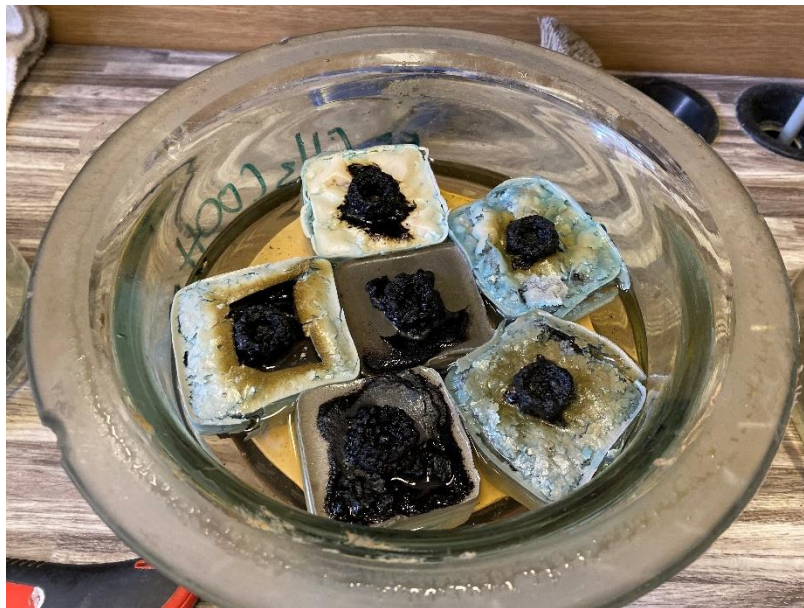
Obrázek 35: Vzorky v chemicky agresivním prostředí \text{CH}_3\text{COOH} (v exsikátoru), po 14-ti dnech, PUR 1
