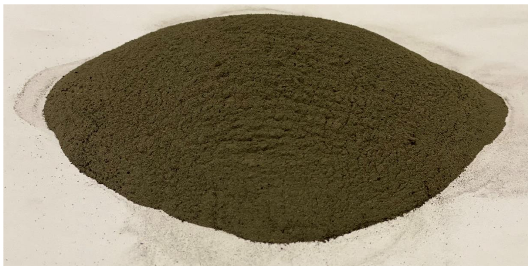
Obrázek 21: Vysokoteplotní popílek použitý jako plnivo do vyvíjených lepicích hmot
