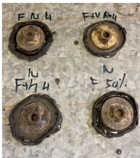
Obrázek 28: Aplikace lepicí hmoty PUR 1 a terče—plechová deska-terče
