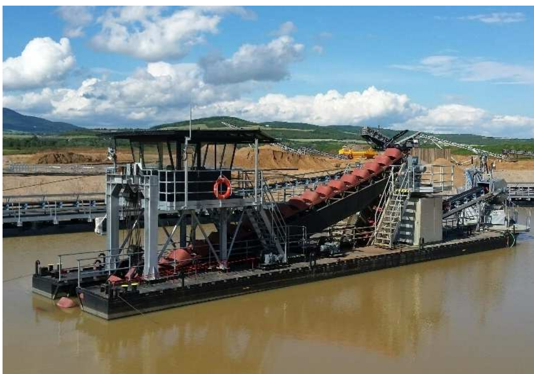
Obr. 25 Plovoucí korečkový bagr [18]
