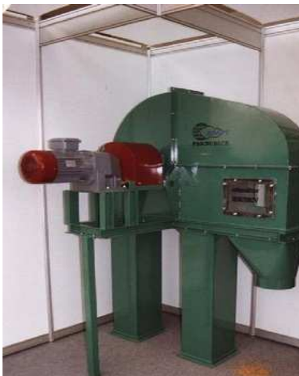
Obr. 9 Uchycení motoru pomocí konzoly [8]
