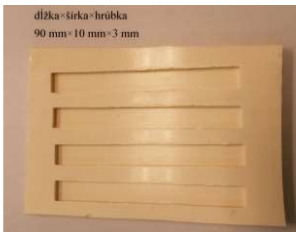
Obrázok 19: Lukoprenová forma na prípravu rámčekov
