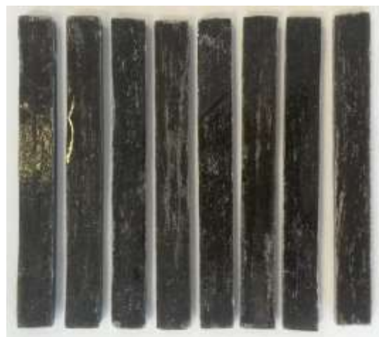
Obrázok 20: Pripravené zabrúsené kompozitné rámčeky
