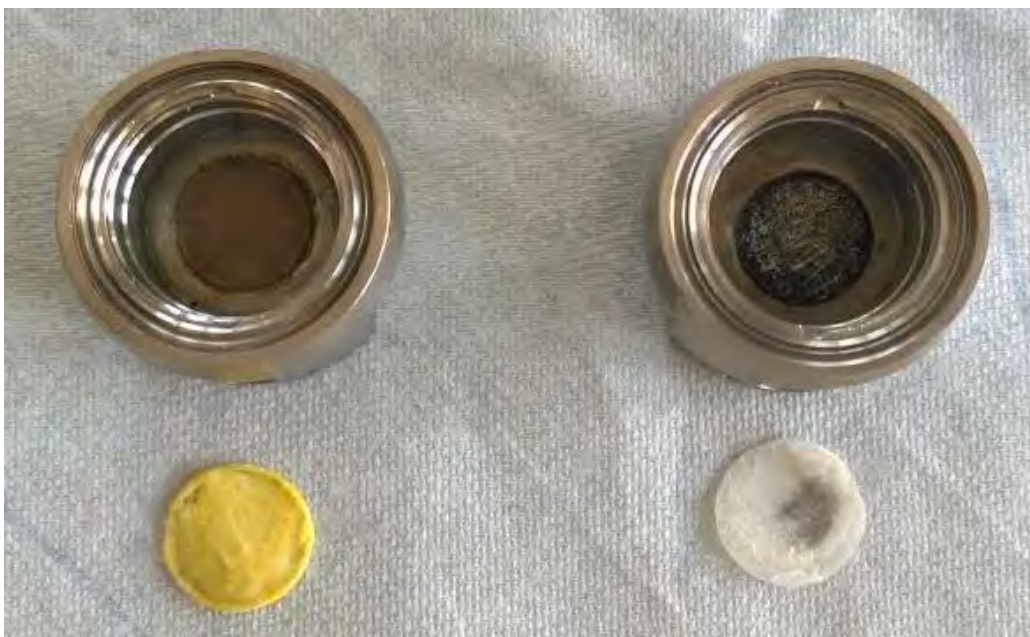
Obrázok 66: Lítium a separátor po cyklovaní - s elektrolytom Sulfolan s DMF vľavo, s elektrolytom Sulfolan vpravo
