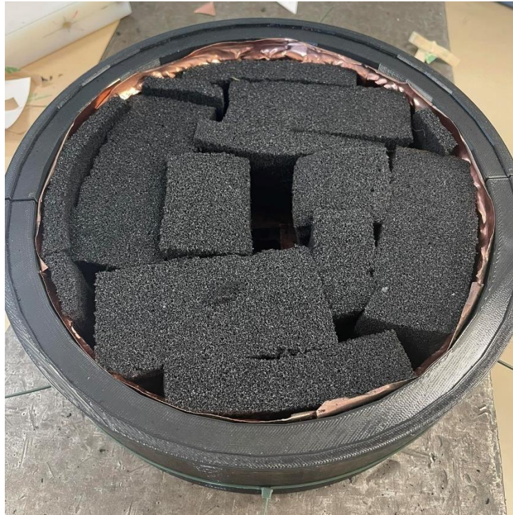
Obr. 5.43 Foto kompletní plechovky s absorbérem
