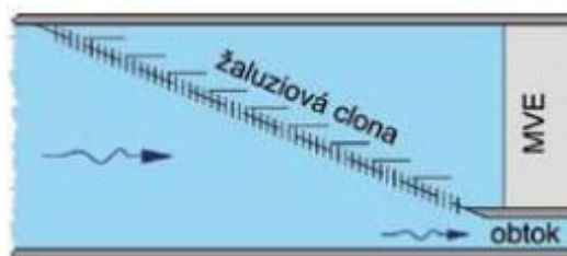
Obrázek 2-3: Přodorysné schéma žaluziové clony. Převzato [24]
