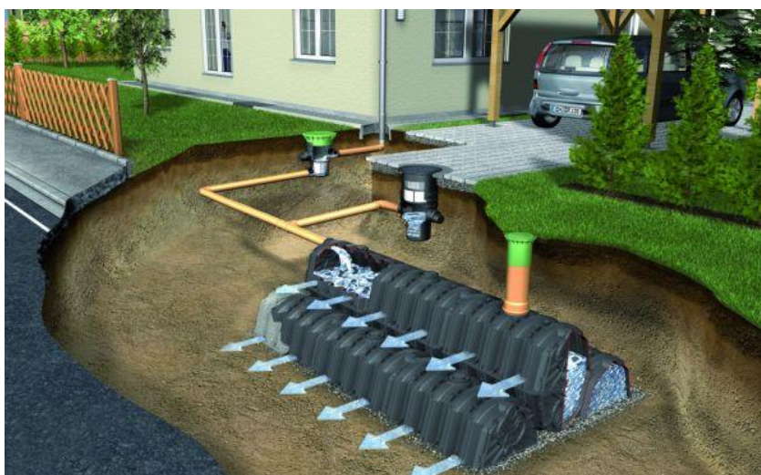
Obr. 6.9 Zasakovací tunel, (nicoll.cz)
