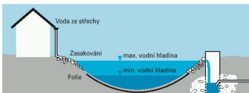
Obr. 6.1 Schéma retenční nádrže u rodinného domu, [4]
