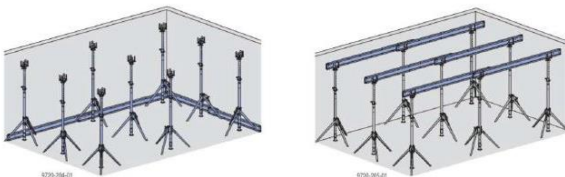
Obrázek 46 – Postup zhotovení bednění stropu Dokaflex 1-2-4 část 1.[17]
