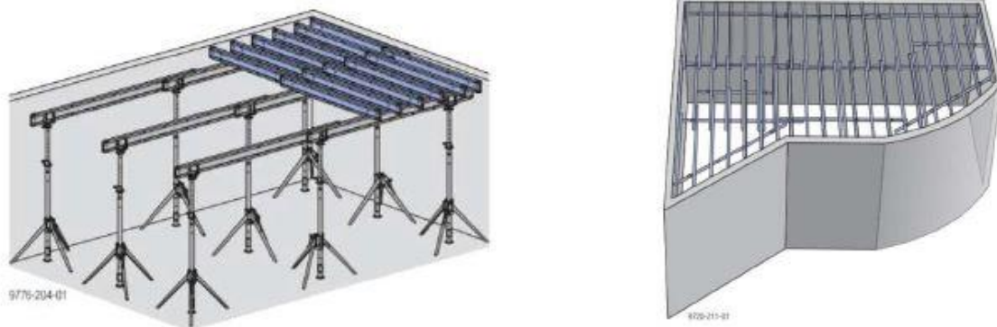
Obrázek 47 – Postup zhotovení bednění stropu Dokaflex 1-2-4 část 2. [17]
