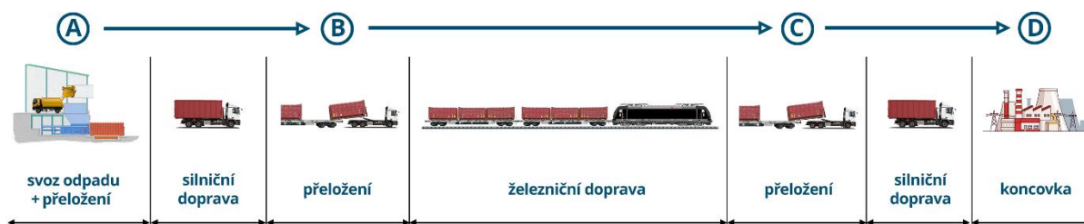
Obr. 2: Ukázka možného dopravního řetězce
