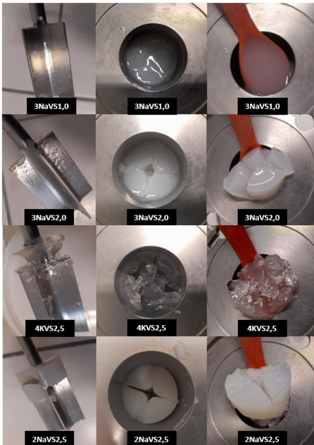
Obr. 29: Vizuální srovnání různých druhů vzorků po ukončení amplitudového testu. Zleva doprava je zobrazeno: měřící geometrie, vzorek v měřícím válci přímo po ukončení měření a test struktury vzorku za použití plastové lžičky
