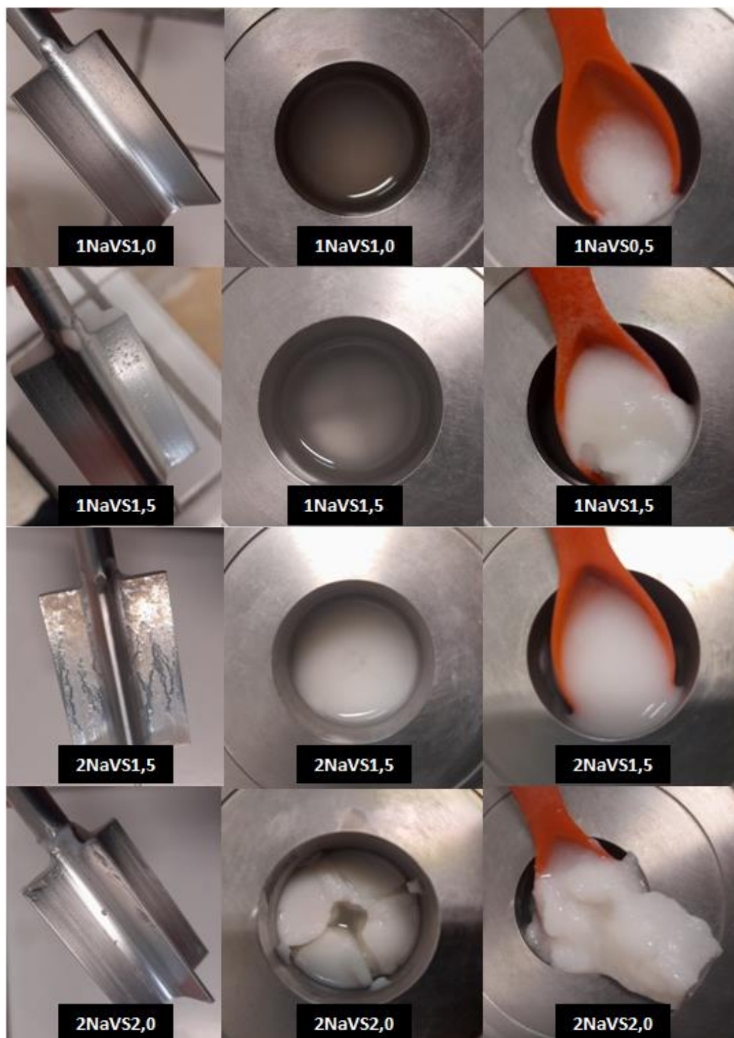
Obr. 28: Vizuální srovnání různých druhů vzorků po ukončení amplitudového testu. Zleva doprava je zobrazeno: měřící geometrie, vzorek v měřícím válci přímo po ukončení měření a test struktury vzorku za použití plastové lžice
