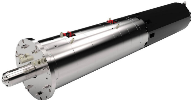
Obr. 20) Vřeteno s vloženým převodem DESCH Denox HS[18]
