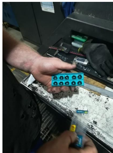
Obr. 19 Výmena starej doštičky za novú.
