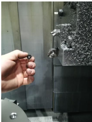
Obr. 18 Výber opotrebovanej doštičky.
