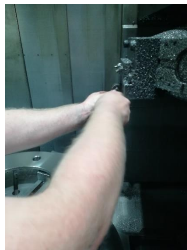
Obr. 21 Upnutie novej reznej doštičky.
