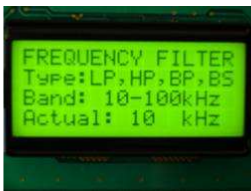
Obr.4.11 Příklad zobrazovaných parametrů na LCD panelu
