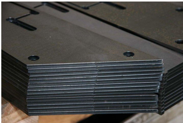
Obr. 10 Detailní pohled na obrobky po dělení laserem [33]
