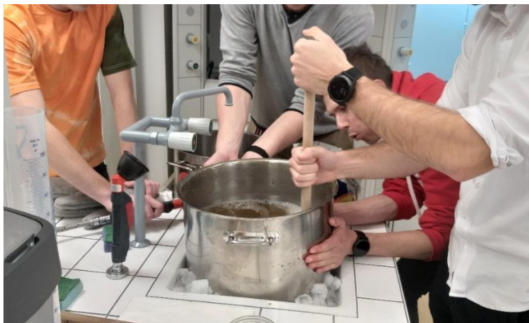
Obrázek 5-8 Chlazení mladiny ve varné nádobě ledem a proudem studené vody
