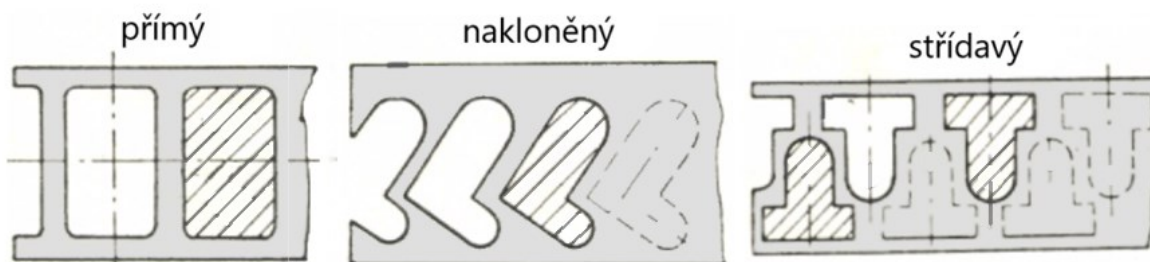
Obr. 36 Příklady rozmístění součástí [26].
