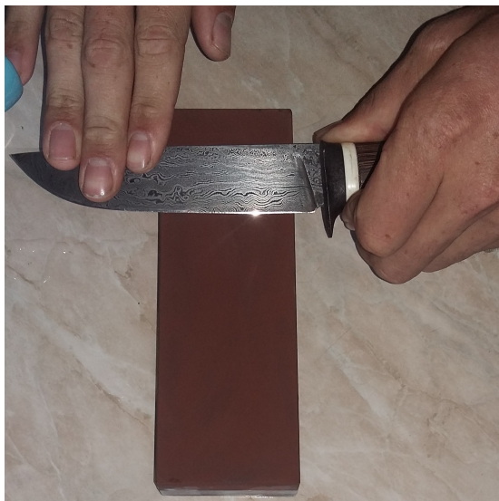
Obr. 40 Broušení fasety na brousicím kameni Suehiro Cerax
