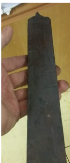
Obr. 23 Po prvním rozkování
