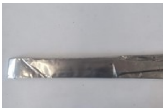
Obr. 31 Zabalení čepele do austenitické folie
