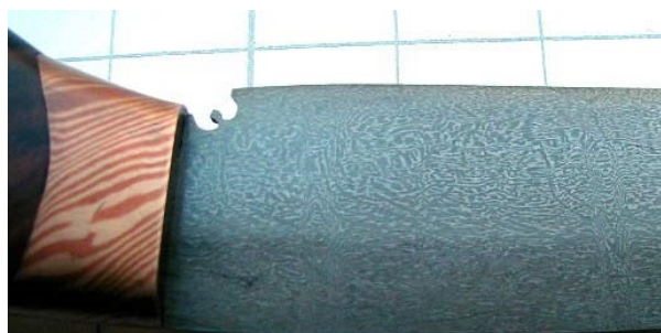
Obr. 6 Damascénská ocel po naleptání [5]
