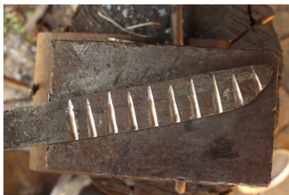
Obr. 27 Vybroušené drážky skrze vrstvy
