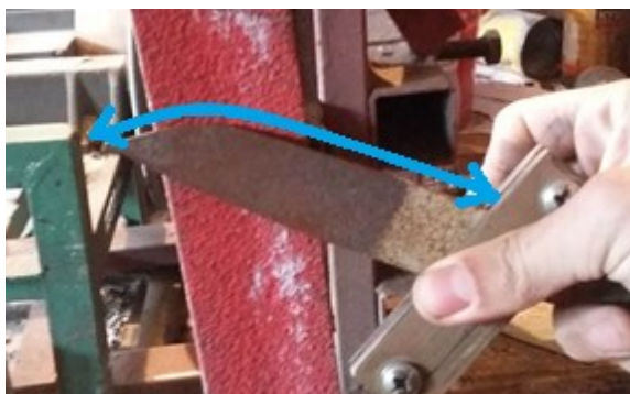
Obr. 28 Kývavý pohyb pro zachování stejného úhlu ostří (znázorňuje modrá šipka)
