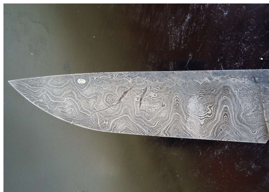
Obr. 42 Vlnovitý vzor se dvěma velkýma prasklinama uprostřed
