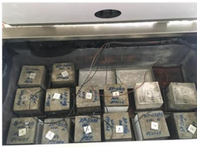
Obrázek 17 - Uložení vzorků ve zkušebním zařízení
