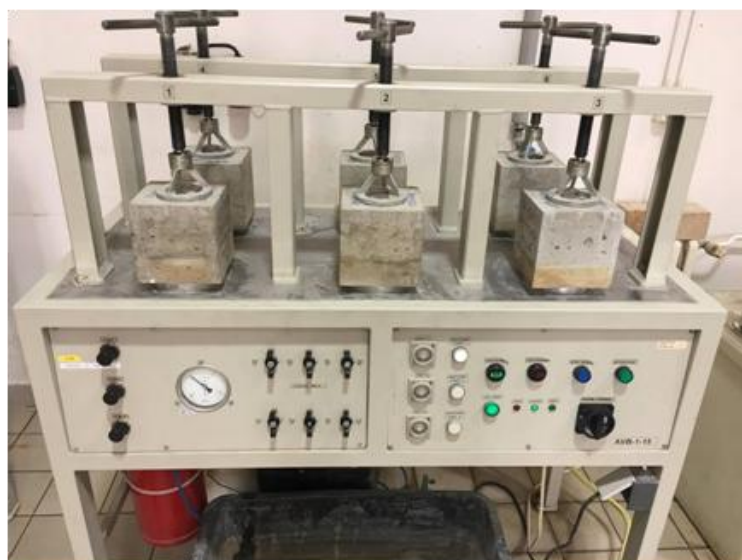
Obrázek 18 - Vzorky upevněné ve zkušebním zařízení pro zkoušku průsaku tlakovou vodou
