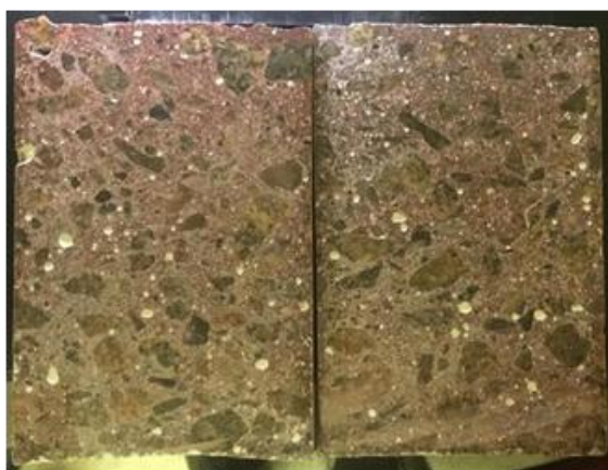
Obrázek 30 - Vzorky pro zkoušku spacing faktoru
