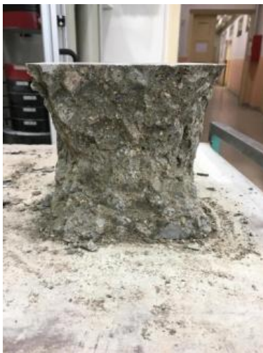
Obrázek 24 - Vzorek po zkoušce pevnosti v tlaku
