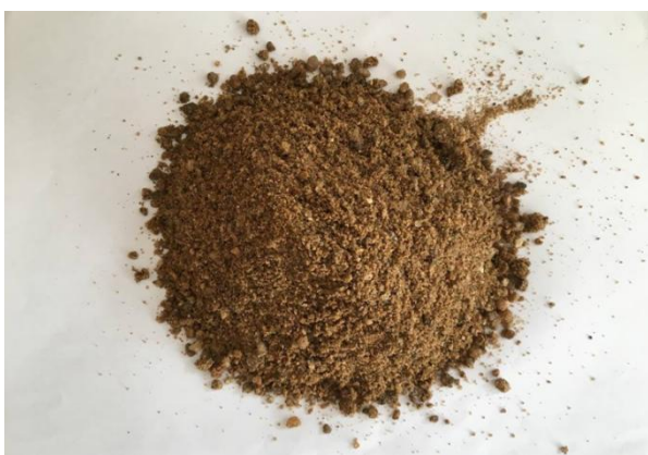
Obrázek 21 - Drobné těžené prané kamenivo, frakce 0/4 Žabčice
