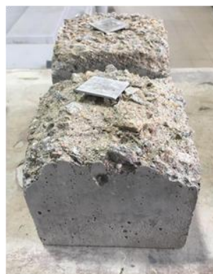
Obrázek 28 - Rozpadlý vzorek R1 REF
