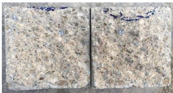
Obrázek 26 - Vzorky po zkoušce hloubky průsaku
