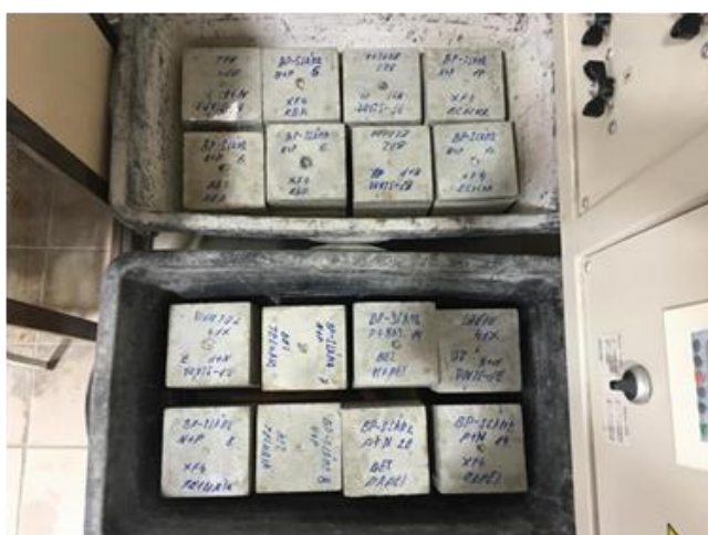
Obrázek 25 - Uložení vzorků ve vodní lázni
