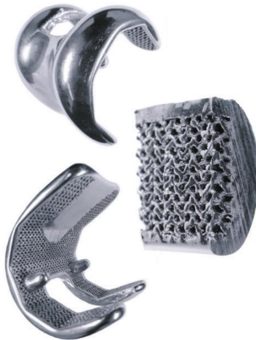
Obr. 3 Porézní struktura komponenty vyrobené technologií EBM [12].
