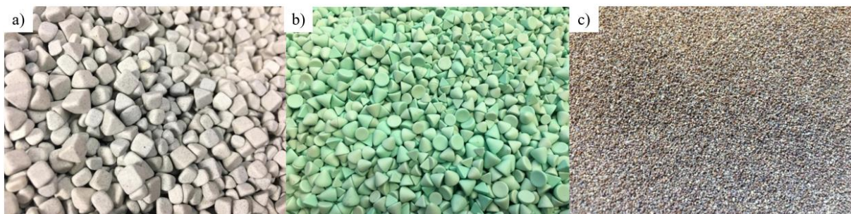
Obr. 25 Abrazivo DBS 6/6 na bázi karbidu křemíku SiC (a) Abrazivo KM 12 na bázi plastické hmoty (b) Abrazivo M5 400 s diamantovými zrnky (c) [7].
