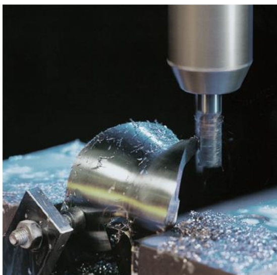
Obr. 23 Frézování femorální komponenty kolenního implantátu [54].
