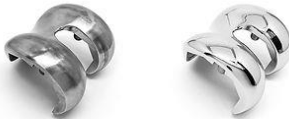
Obr. 29 Ukázka povrchu kolenního implantátu před (vlevo) a po (vpravo) projitím systému DLyte [57].
