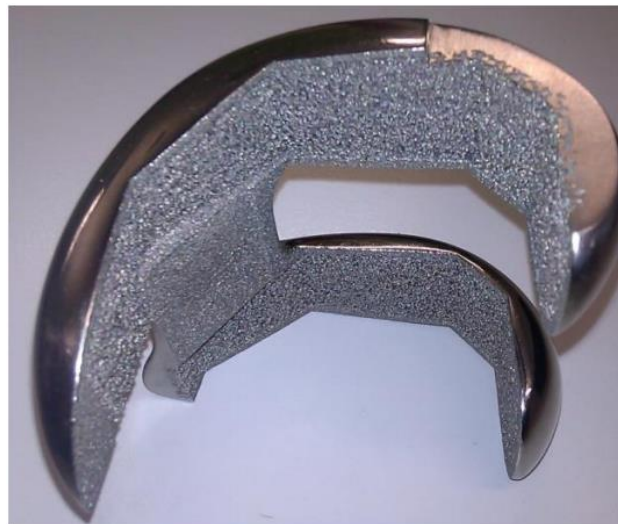
Obr. 22 Ukázka kolenního implantátu s porézní i hutnou strukturou vyrobeného pomocí technologie EBM [7].
