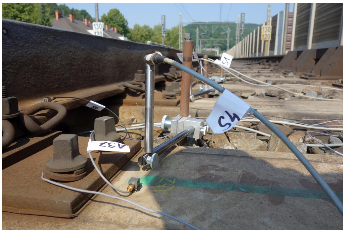
Detailní pohled na indukční snímač upevněný pomocí speciálního držáku a instalovaný piezoelektrický snímač zrychlení vibrací
