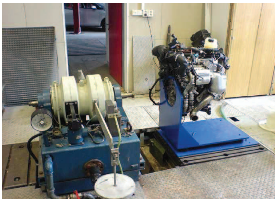
Obr. 50: Systém uchycení motoru Peugeot 406 2,2HDI pomocí L-desky k dynamometru V250 [17]
