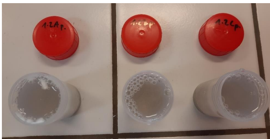
Obrázek 15: Bublinky plynu a plíseň u vzorku NPK 2 v destilované vodě.
