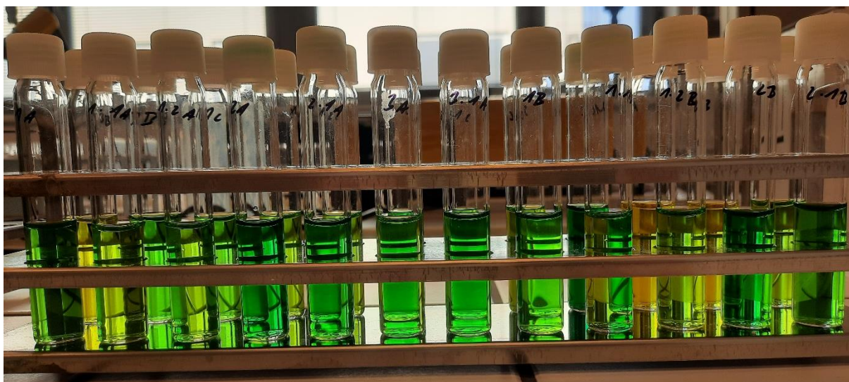
Obrázek 12: Vybarvená sada vzorků pro měření amonných iontů.
