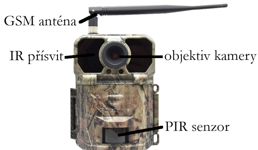
Obr. 2.2: Popis základních částí GSM fotopasti (upraveno z [14]).
